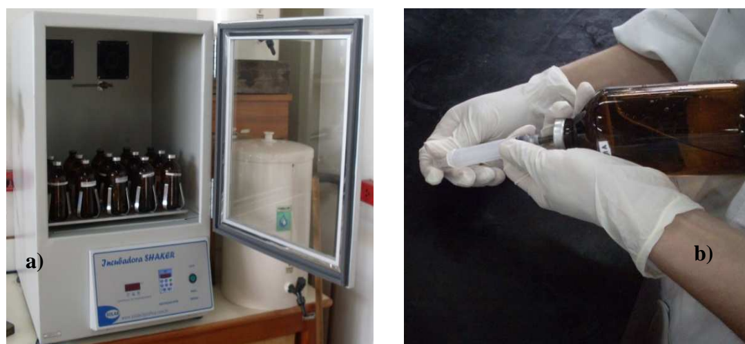
Figura 4.2 – Incubadora shaker utilizada nos ensaios e detalhe da coleta de amostra dos frascos-reatores (a) e detalhe do procedimento de coleta de amostras para análise (b).
