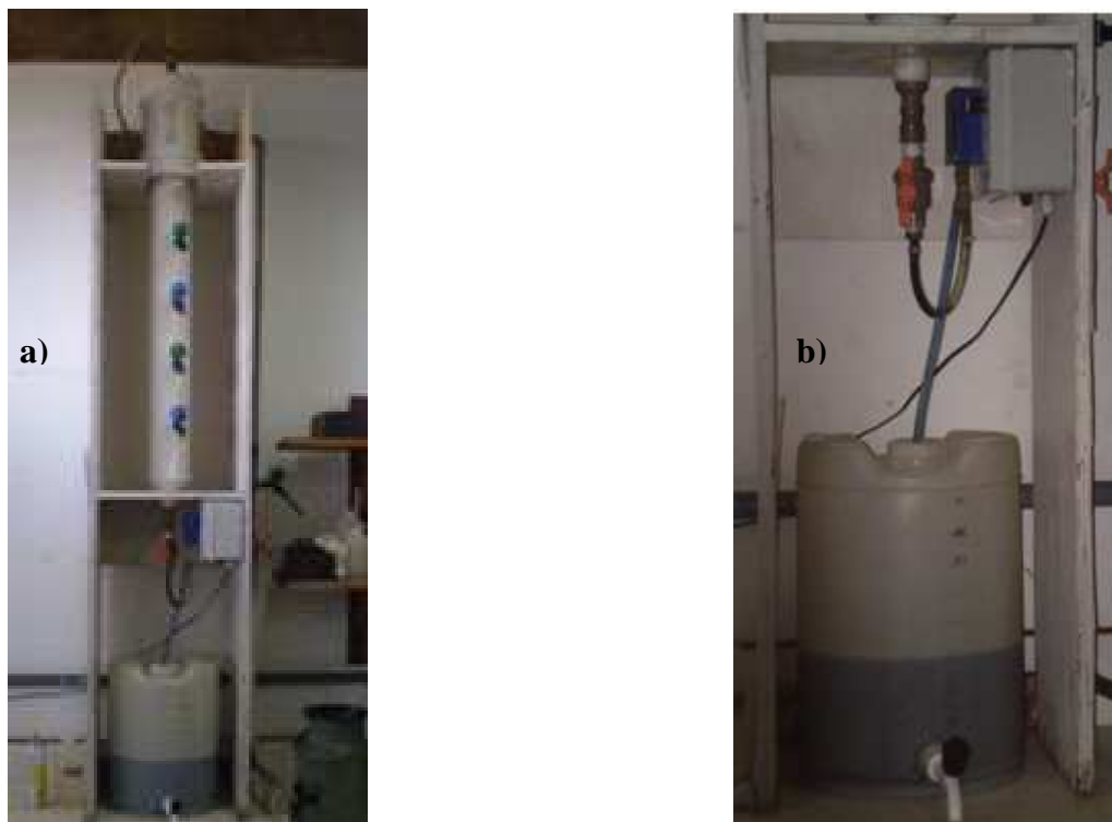
Figura 4.5 – Foto do reator UASB de bancada utilizado (a) e detalhe do sistema de alimentação do referido reator (b).
