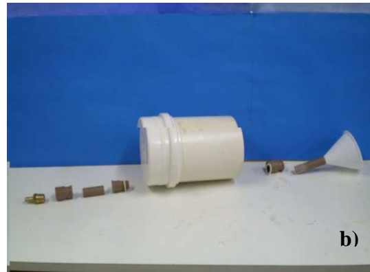
Figura 4.3 – Material utilizado na construção do reator UASB de bancada constituído pela câmara de digestão (a) e pelo separador trifásico na câmara de decantação (b).
