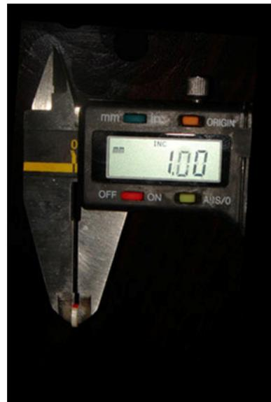
FIGURA 26 - Aferição da espessura dos espécimes com paquímetro
