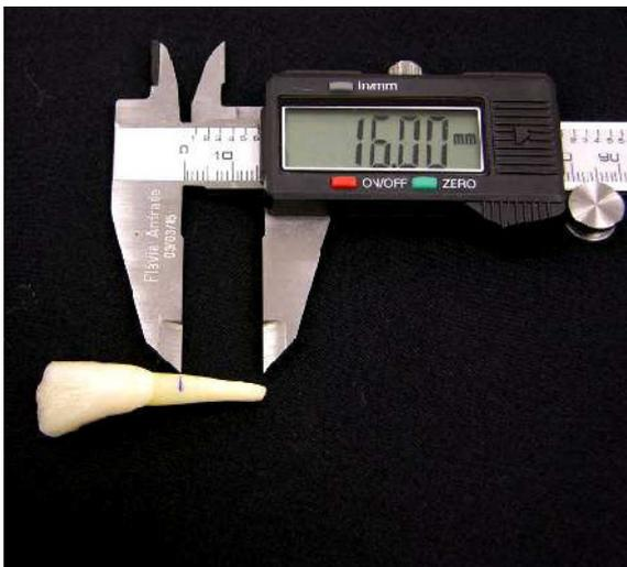
Figura 7- Medição da porção radicular para padronização da amostra
