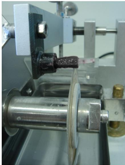
FIGURA 25 - Seccionamento das raízes com disco diamantado em baixa rotação
