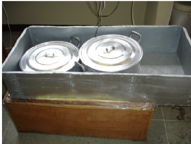
Figura 5 - Banho termostático de fabricação artesanal.
