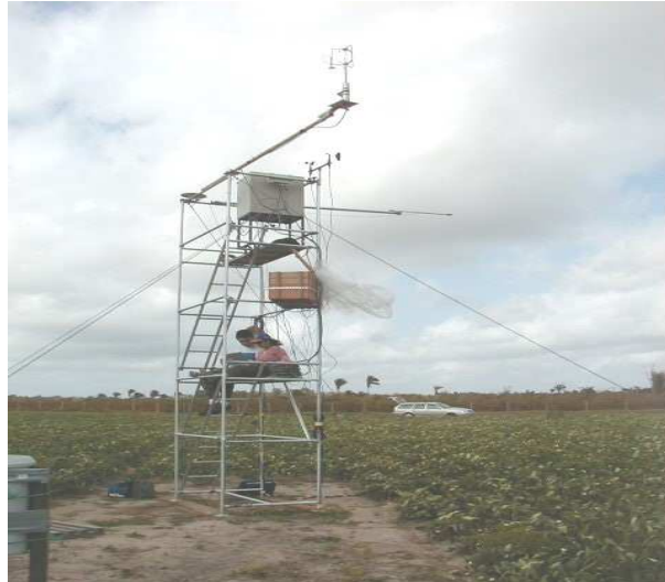
Figura 1. Torre micrometeorológica no centro da cultura de caupi.
