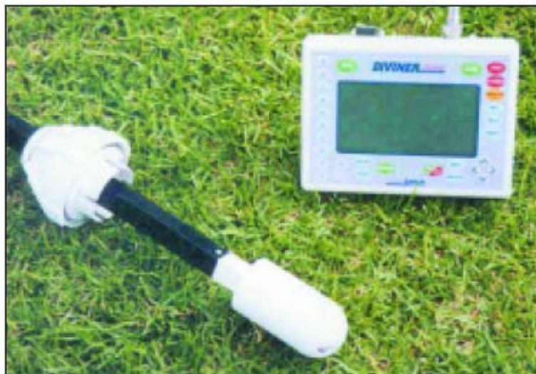
Figura 05 - Sensor Diviner 2000 utilizado para as medidas de umidade do solo.
