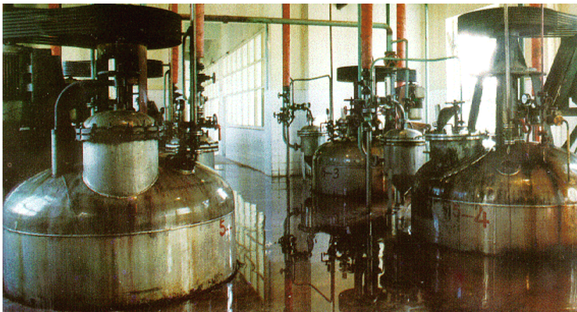
Figura V.21 – Fermentadores industriais utilizados na produção de pigmentos vermelho (fermentação sólida) a partir do arroz. Fonte: (ALLOK, 2001).
