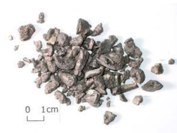
Figura 19 - Aspecto dos finos de esponja de titânio utilizados para obtenção de pós.
