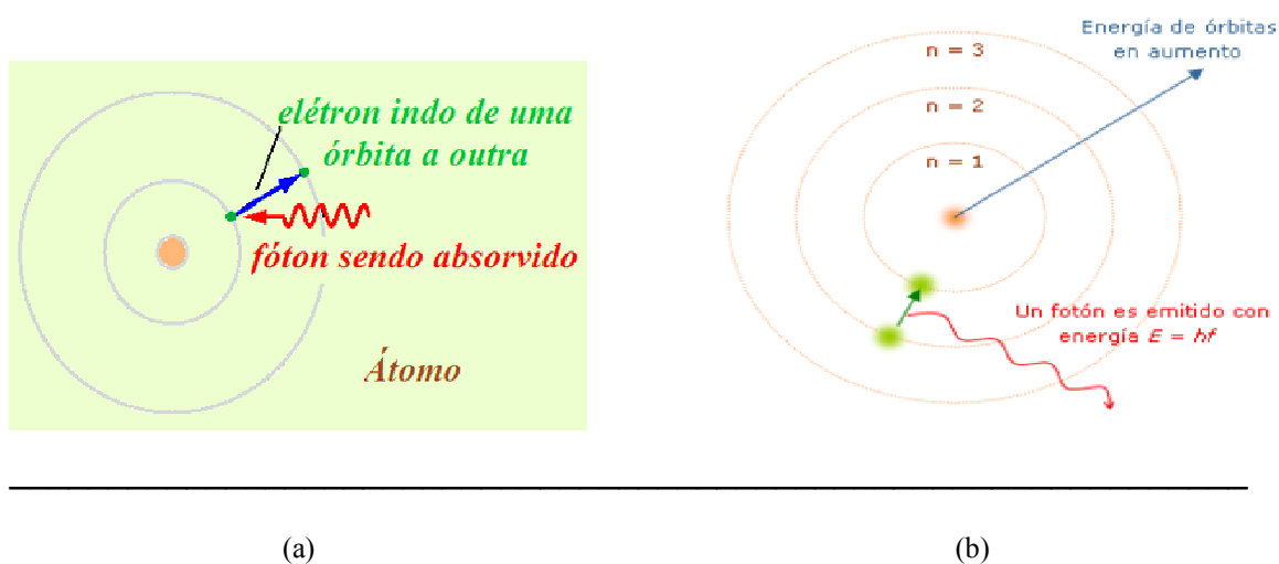
Figura 6 – Representação esquemática dos níveis energéticos para o modelo atômico de Bohr (a) Absorção de energia e (b) Emissão de energia ( www.google.com.br/imagens ).
