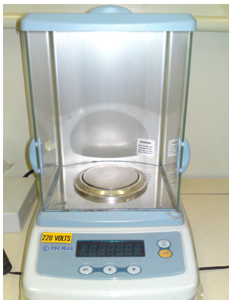
Figura 2 – balança eletrônica de precisão Tecnal, Mark 210 A .
