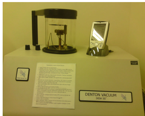
Figura 8 – Equipamento utilizado para deposição metálica sobre as amostras.
