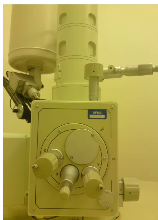
Figura 10 – Coluna ótico-eletrônica, detector e câmara de amostras.
