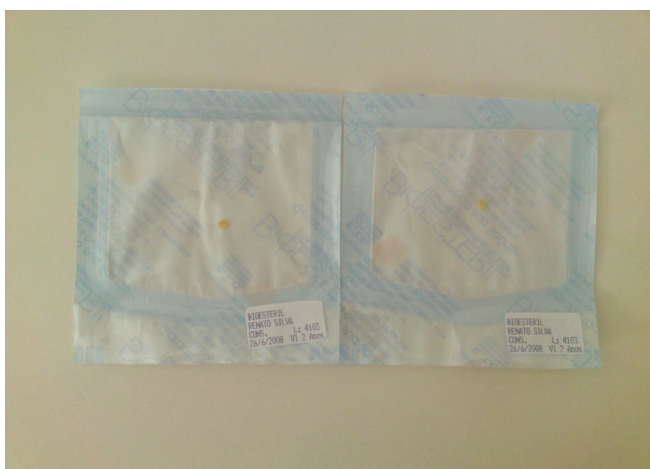
Figura 4 – bloco pré-fabricado do polímero de mamona esterilizado individualmente por óxido de etileno.
