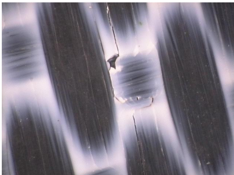
Figura 4.4 – Falha do corpo-de-prova em flexão de três pontos.
