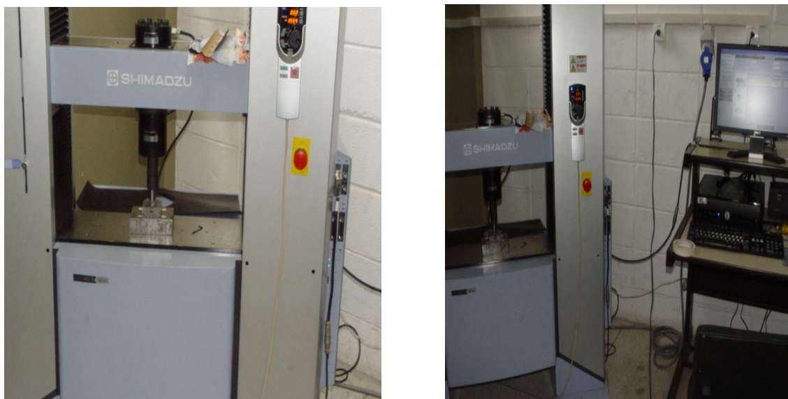
Figura 3.13 – Equipamento SHIMADZU SFL-50kN para realização dos ensaios de flexão em três pontos do Laboratório de Ensaios Mecânicos do Departamento de Materiais e Tecnologia da UNESP em Guaratinguetá/SP.
