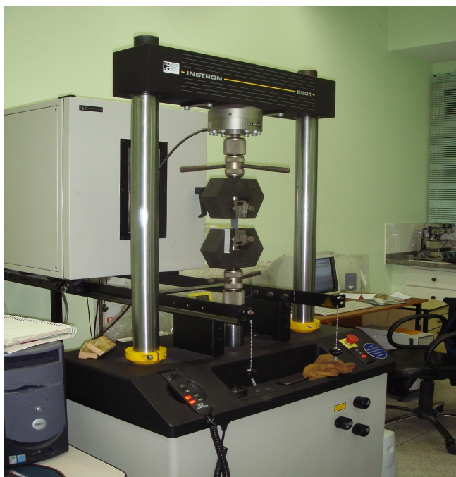
Figura 3.8 – Equipamento de Ensaio universal INSTRON modelo 8801, realizado no Laboratório de Fadiga do Departamento de Materiais e Tecnologia da UNESP, em Guaratinguetá/SP.
