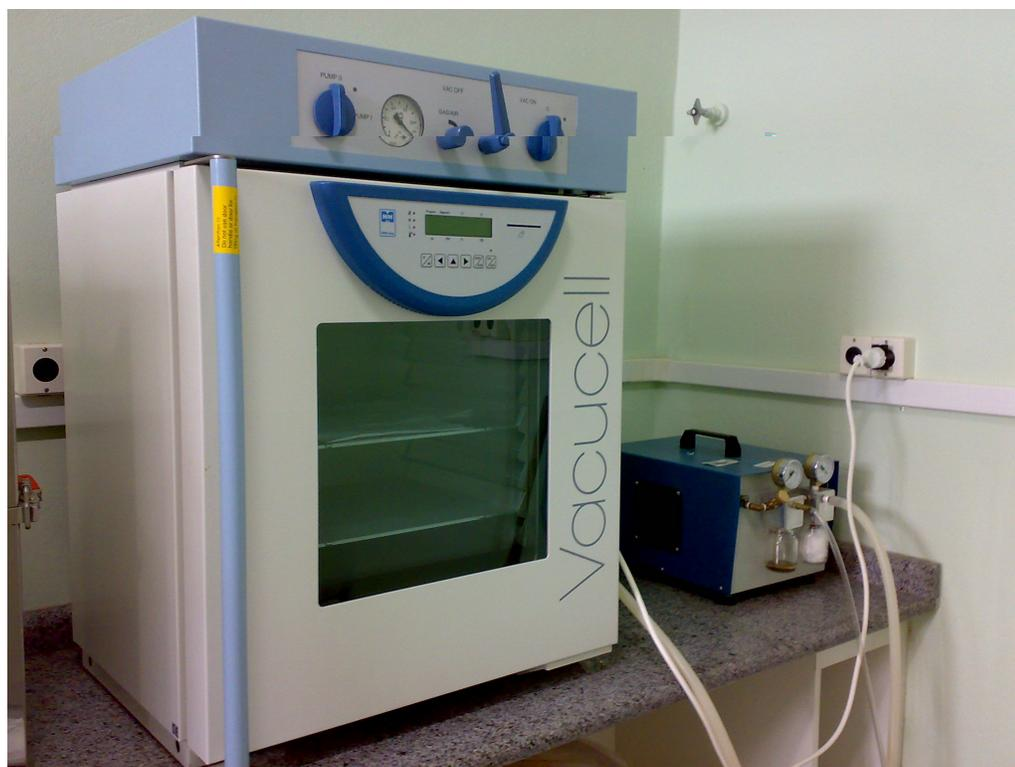
Figura 3.8. Estufa a vácuo da marca Vacucell.
