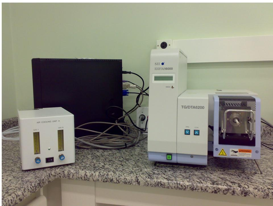
Figura 3.5. Equipamento de TG da Seiko, modelo TG/DTA 6200, utilizado.
