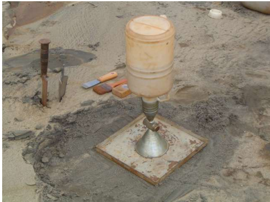
Figura 4.12 – Visão geral do esquema de determinação da densidade através do método do Frasco de Areia.
