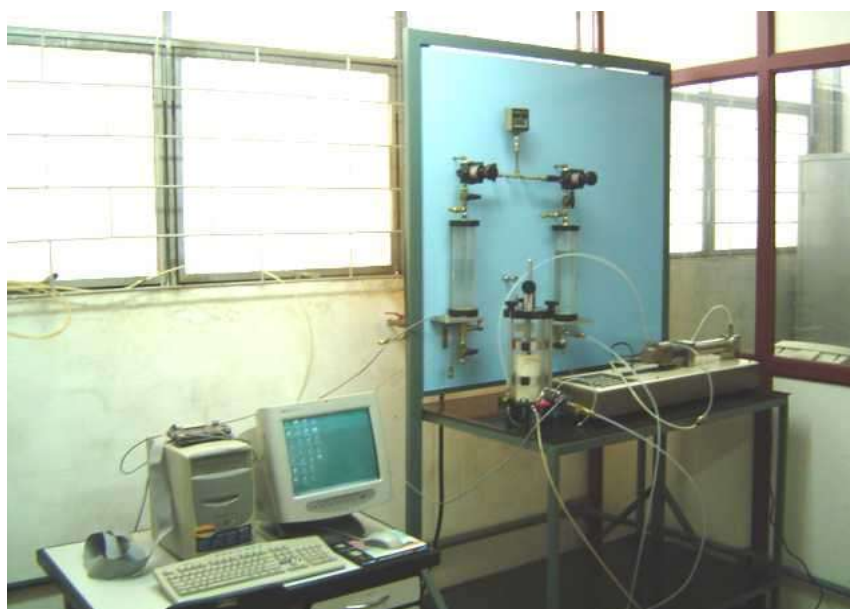
Figura 4.14 – Visão geral do equipamento utilizado na determinação da condutividade hidráulica através da bomba de fluxo.
