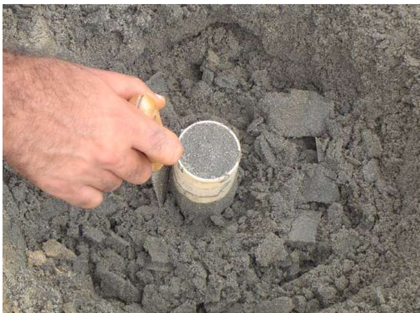
Figura 4.11 – Visão geral do esquema de determinação da densidade através do método do Cilindro Biselado.
