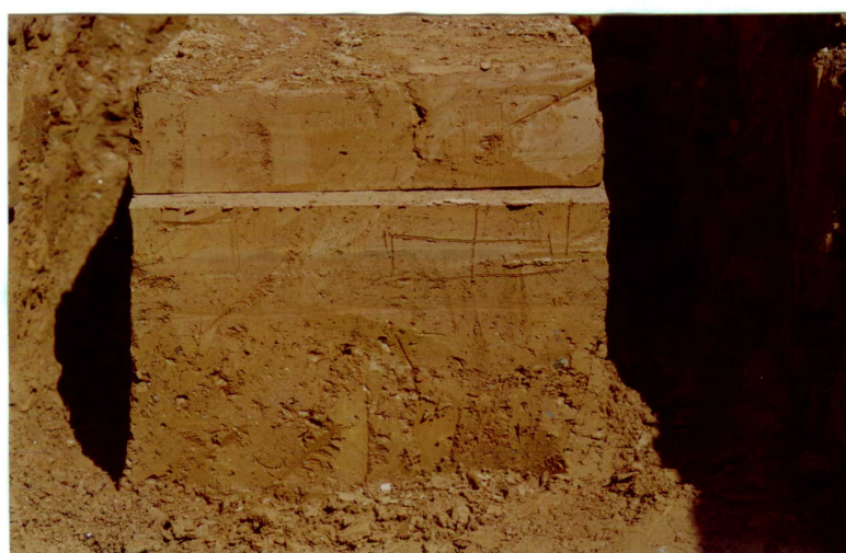
Foto 4.2 – Amostragem do bloco indeformado no fundo da Cava do Germano.
