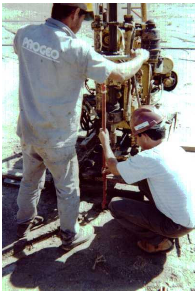
Foto 5.4 - Utilização do trado manual para perfurar 1,5m para o primeiro ensaio com o pressiômetro.
