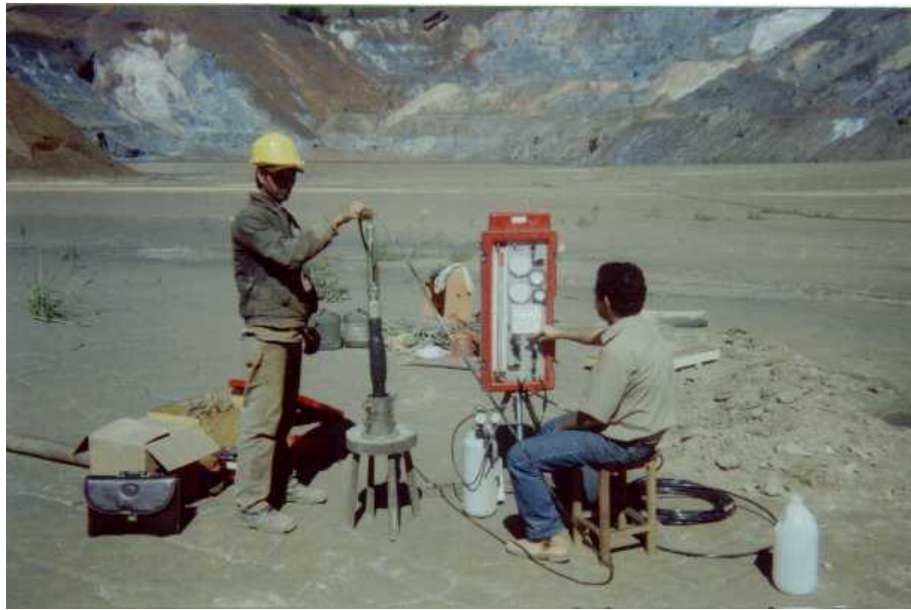
Foto 5.3 - Calibração da sonda pressiométrica ao ar (pressão aplicada até 150kPa).
