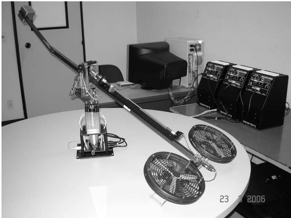
FIGURA 5.2 – Helicóptero utilizado no trabalho.
