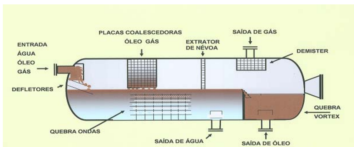
Figura 9 – Vaso Separador Multifásico Fonte: Universidade PETROBRAS
