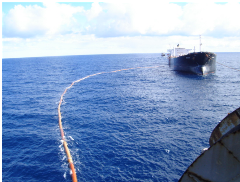
Foto 7 – Operação de offloading. Ao fundo o navio petroleiro aliviador. Fonte: PETROBRAS
