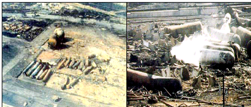
Foto 4 - BLEVE em esferas de GLP na cidade do México Fonte: Yokohama National University – Case of Study (site acessado em fevereiro 2007)
