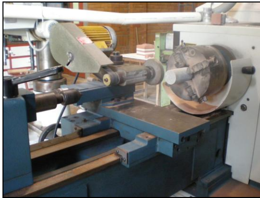
Figura 4.25 – Faceamento das amostras em torno mecânico
