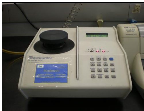
Figura 4.4 – Picnômetro a Gás AccuPyc 1330
