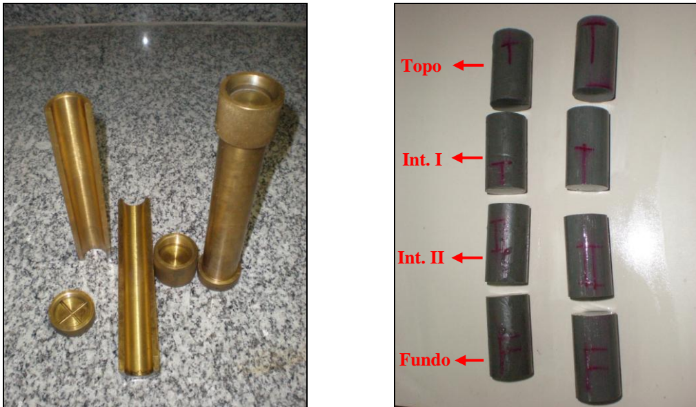
Figura 4.23 – (a) Tubo decantado e (b) amostras
