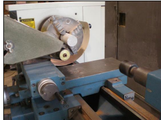
Figura 4.25 – Faceamento das amostras em torno mecânico
