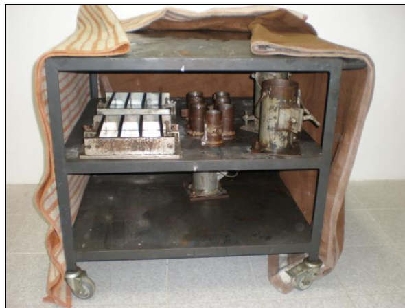
Figura 4.12 – Cura dos corpos-de-prova durante as primeiras 24h
