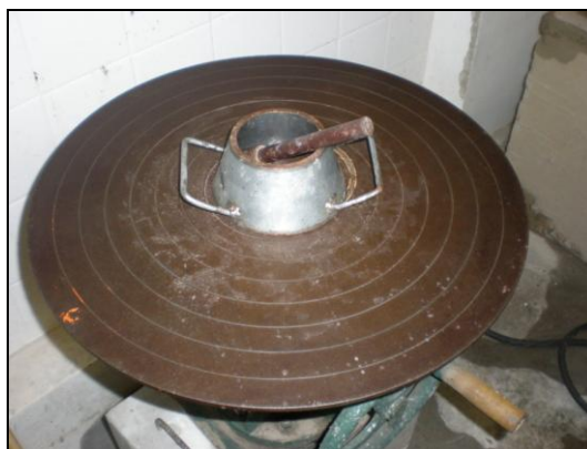
Figura 4.20 – Mesa de espalhamento com molde tronco-cônico
