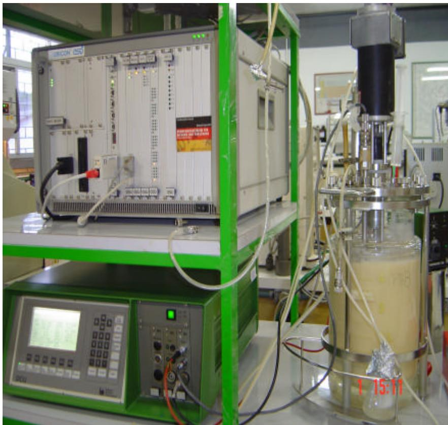
**Figura 2.1.** Dispositivo experimental de cultivo em biorreator
