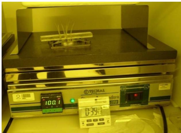
**Figura 9** – Cura do PDMS: transição líquido → sólido.
