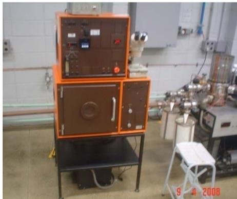
**Figura 11** – Foto do equipamento de plasma de O<sub>2</sub> utilizado na selagem dos chips.
