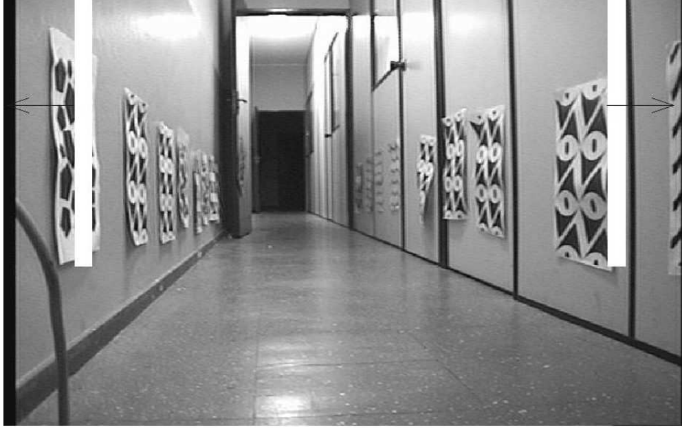
Figura 8: Componentes horizontais do fluxo óptico medido nas paredes do corredor, quando o robô está no seu centro.
