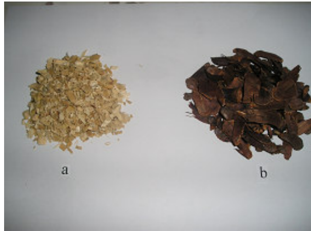
Figura 4.1. Imagens: a) Material Precursor - Serragem; b) Material Precursor - Pinha do Pinus elliotti .
