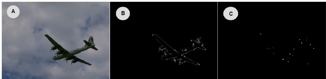
Figura 3.3: Imagem Original(A), valores de R > \text{limiar} (B) e os máximos locais ou cantos (C)
