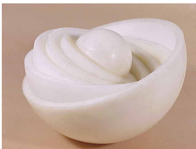
Figura 4.4 - Camadas de um núcleo de uma lente de Luneberg.
