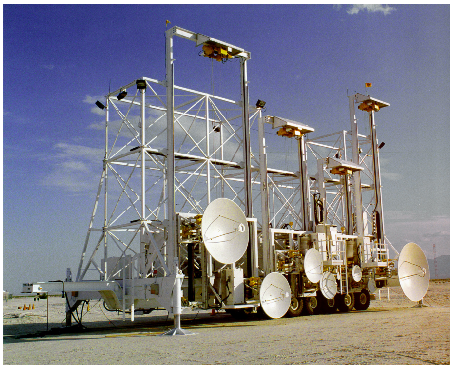
Figura 2.3 – Equipamentos para medida de refletividade de alvos reais ( RATSCAT – Holloman - Novo México) 23 .
