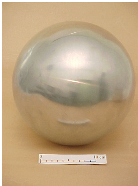
Figura 4.6 - Esfera metálica utilizada como alvo.
