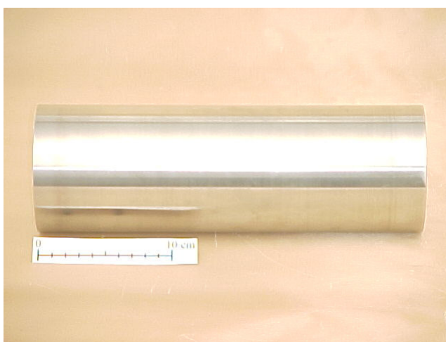
Figura 4.10 – Cilindro de 30 cm de comprimento e 10 cm de diâmetro.
