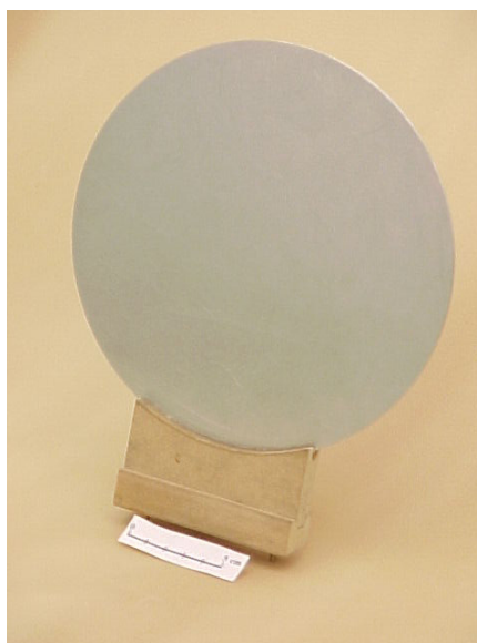
Figura 4.9 – Disco de alumínio de 20 cm de diâmetro utilizado como alvo.
