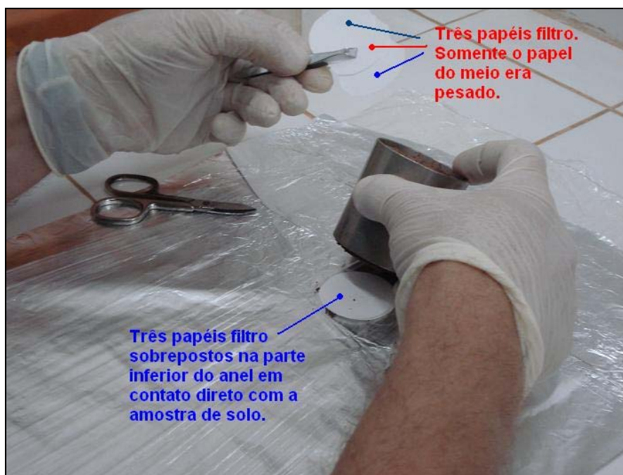
Figura 3. 47 – Colocação do papel filtro na amostra indeformada de solo.
