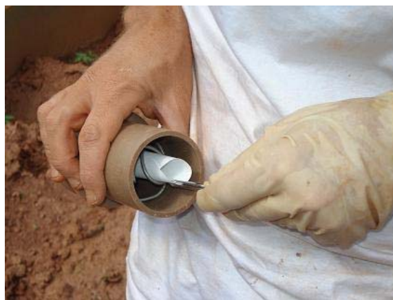
Figura 3. 44 - Colocação do papel filtro de 7 cm enrolado no arame espiralado dentro do tubo.
