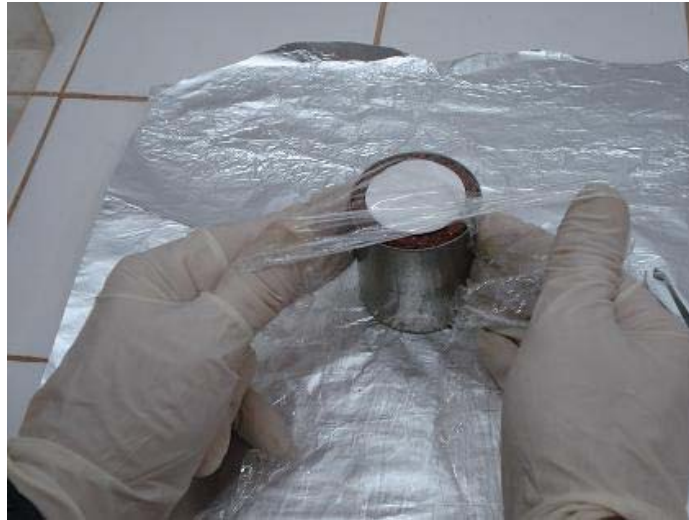
Figura 3. 48 – Filme de PVC envolvendo a amostra com papel filtro para conter a umidade e permitir a equalização da água do solo e do papel filtro.
