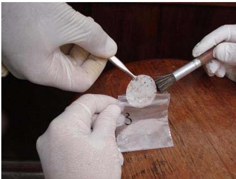
Figura 3. 52 – Retirada de impurezas do papel filtro.
