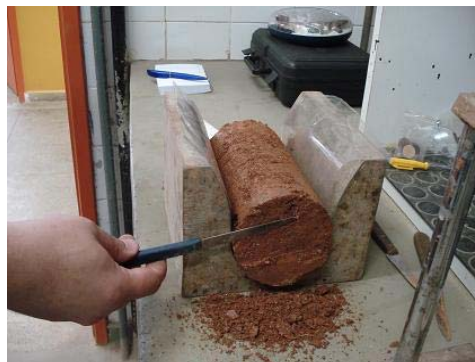
Figura 3. 65 – Moldagem do corpo de prova.
