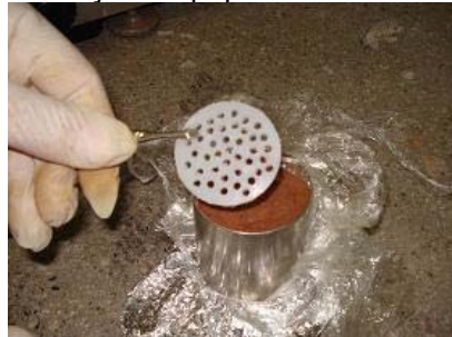
Figura 3. 55 - Detalhe da placa perfurada.
