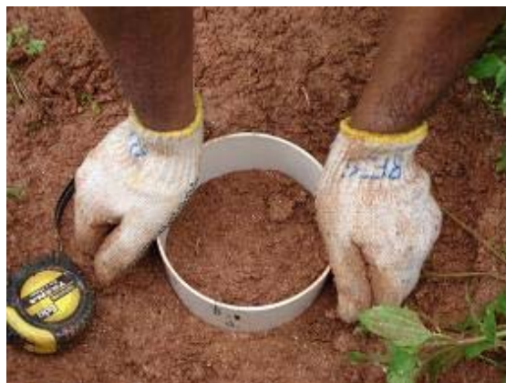
Figura 3. 5 - Cravação do anel da amostra para ensaio de Inderbitzen.
