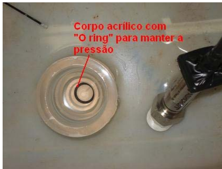
Figura 3. 28 – Bacia com água destilada e deaerada para efetuar o acoplamento do transdutor no corpo acrílico de forma submersa.
