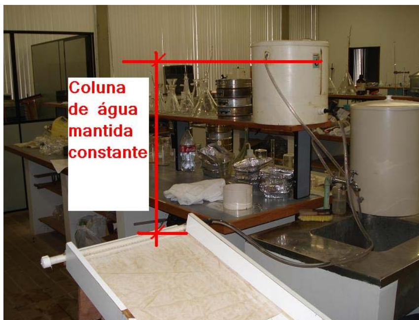
Figura 3. 61 - Detalhe do controle de vazão.
