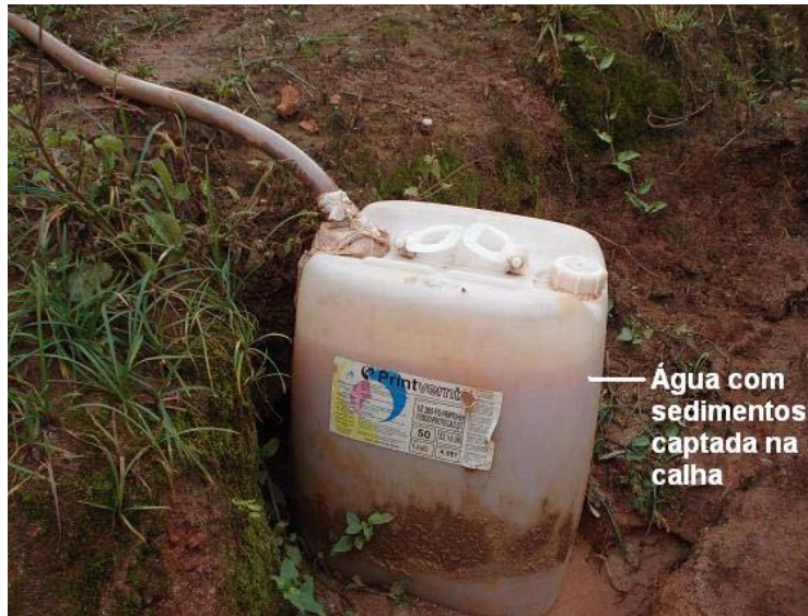
Figura 3. 14 - Coleta da água de escoamento superficial.
