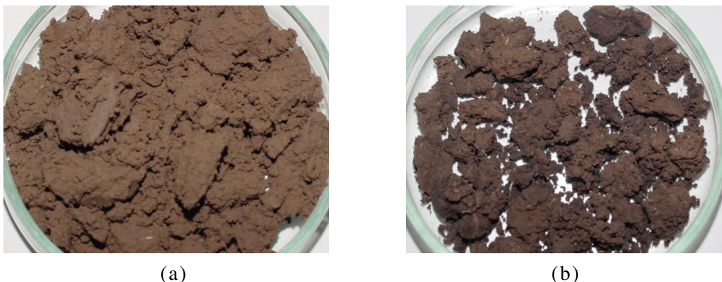
Figura 5.12: Biomassa-SF com 70% (a) e 15% (b) de umidade.
