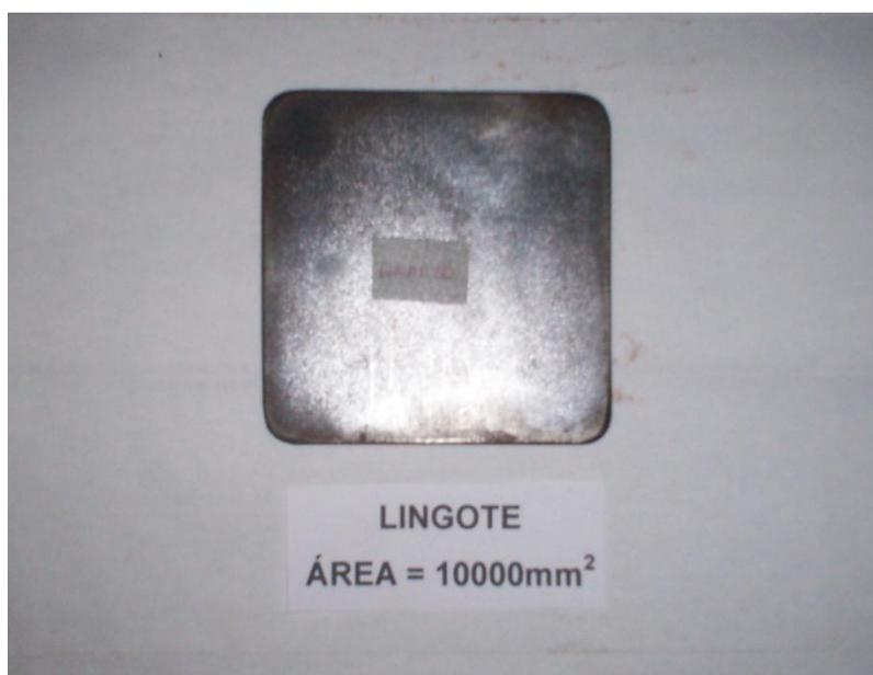
Figura 3.8 – Área da seção transversal do lingote de 10 X 10 cm
