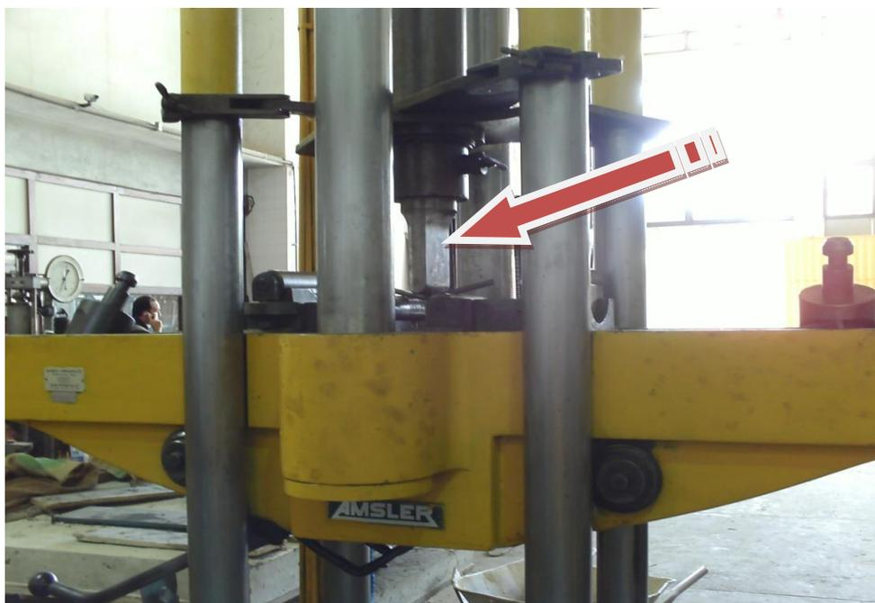
Figura 3.37 – Máquina universal de ensaios - Pino aplicado para a realização do ensaio de dobramento a 180°
