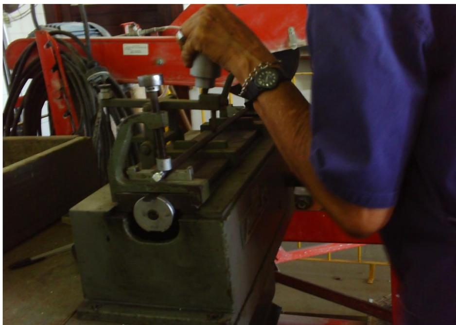
Figura 3.36 – Equipamento para a marcação preliminar para a determinação do alongamento % após a ruptura em 10 Ø.
