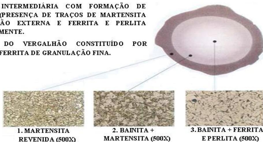
Figura 2.29 – Corte em secção transversal de vergalhão com tratamento térmico superficial. Visualização das regiões afetadas através da transferência de calor (ALVES, 2004)
