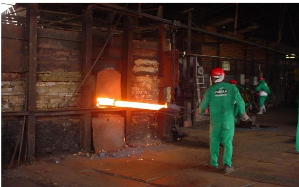
Figura 3.27 - Forno de reaquecimento de lingotes na laminação
