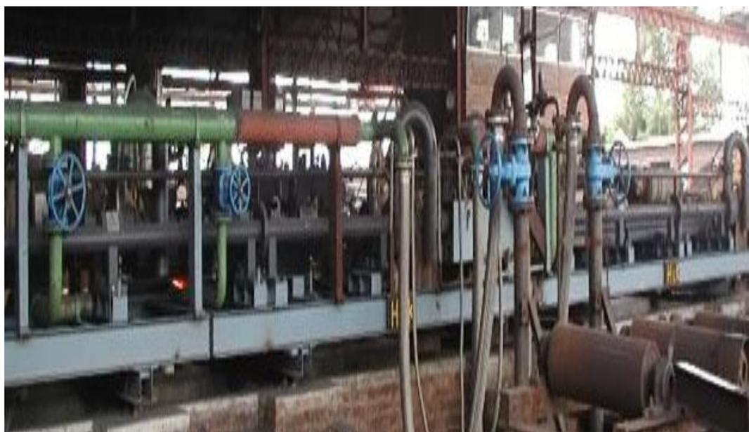
Figura 2.6 – Instalação Thermex para resfriamento de barras (TAMM, 2003)
