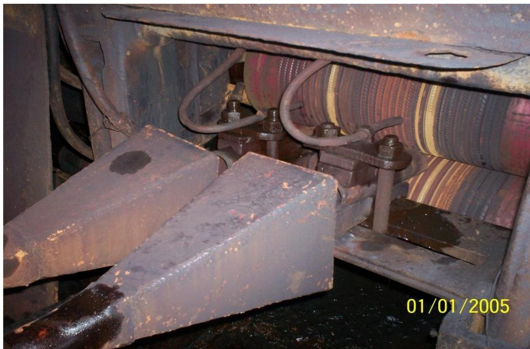
Figura 3.28 - Cilindro do trem acabador
