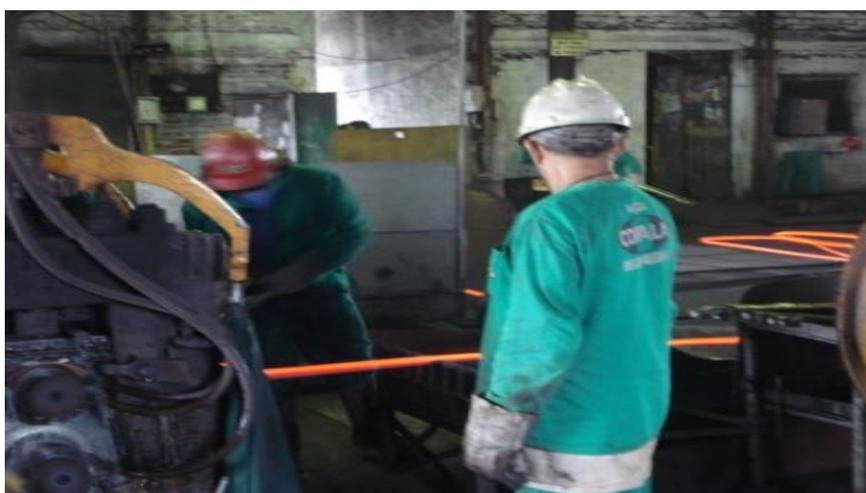
Figura 3.21 - Passagem dos lingotes pelo ultimo estágio de laminação (trem acabador)
