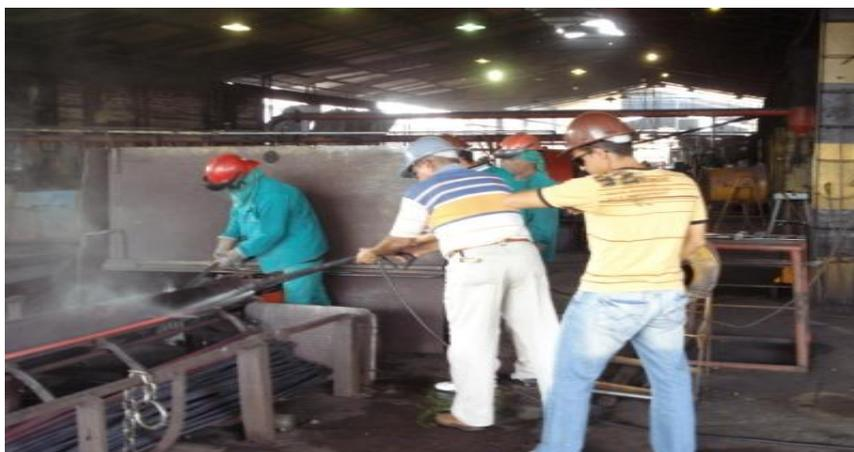
Figura 3.23 - Resfriamento brusco das barras (após trem acabador)
