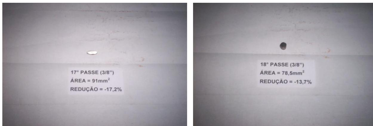
Figura 3.7 Taxa de deformação nos dois últimos passes da laminação para a produção do vergalhão Ø 10 mm.
