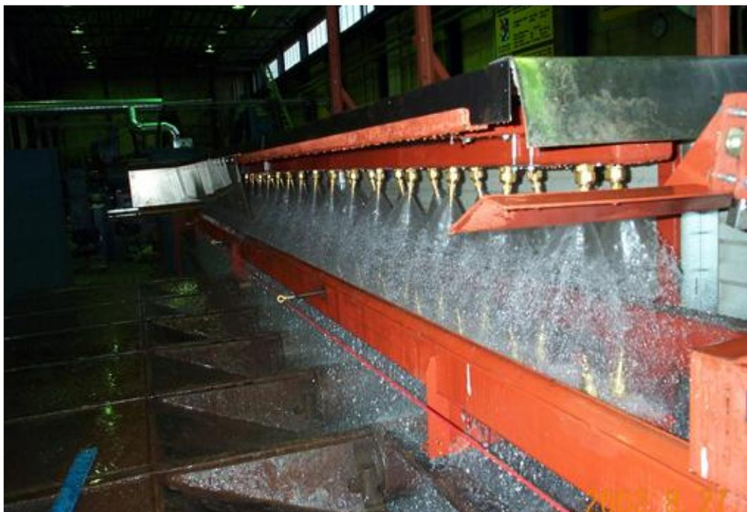
Figura 2.5 – Sistema de resfriamento com água (MEFOS, 2008)
