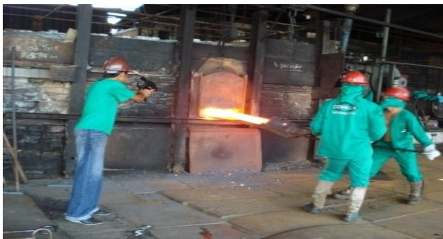
Figura 3.18 - Desenformamento dos lingotes e medição de temperatura
