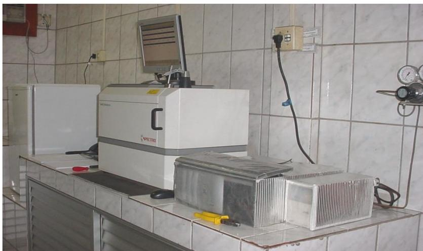
Figura 3.9 – Espectrômetro para realização de análises químicas
