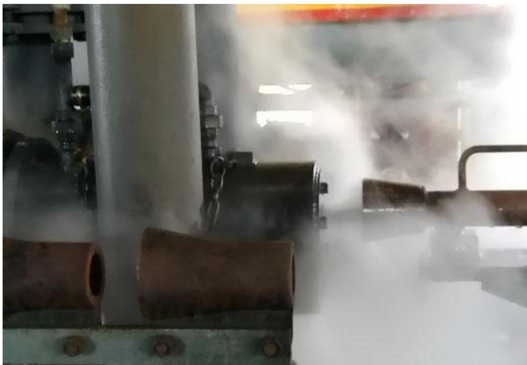
Figura 2.3 – Equipamento para resfriamento de barras (TAMM,2003)
