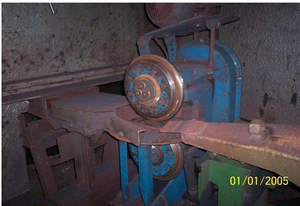
Figura 3.29 - Tesoura de corte das barras
