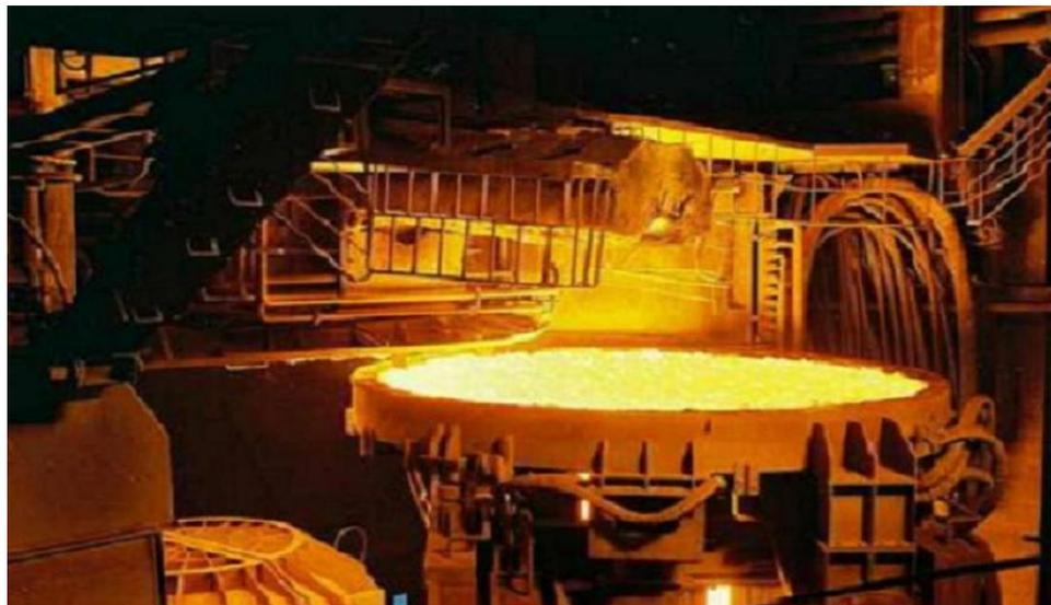
Figura 3.3 – Forno a arco elétrico
