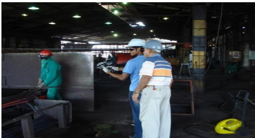
Figura 3.22- Medição de temperatura antes do resfriamento
