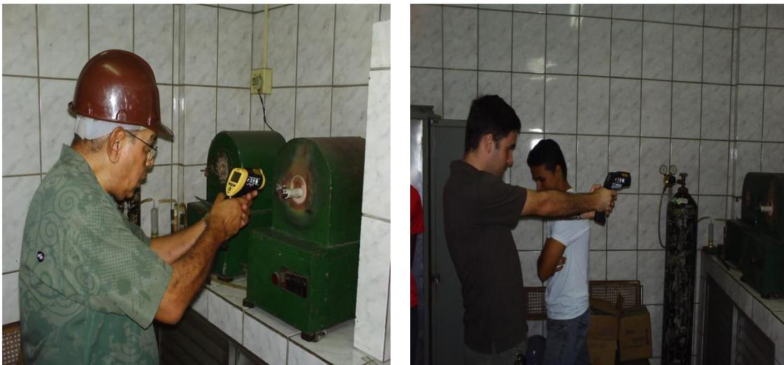
Figura 3.32 - Pirômetros óticos e forno usado para austenitização das amostras do primeiro experimento
