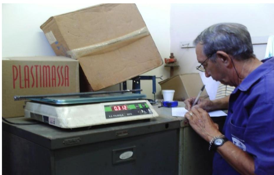
Figura 3.35 – Balança para a pesagem das barras para a determinação da densidade linear de massa.
