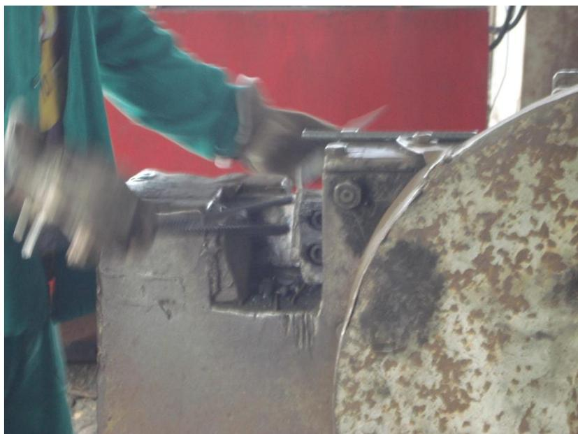
Figura 3.10 – Prensa tesoura para o corte das amostras
