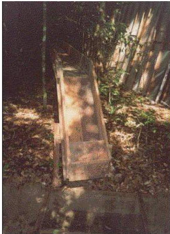
Figura 4 – Calha de madeira para escoamento de água nas trincheiras. Experimento ESECAFLOR.
