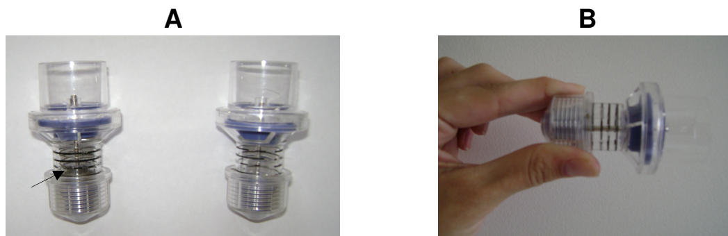
FIGURA 6 - A: Foto ilustrativa das válvulas spring-load . A da esquerda mostra a válvula com mola (apontada pela seta); a da direita mostra a válvula sem a mola. B: Outra visão da válvula sem mola (placebo).
