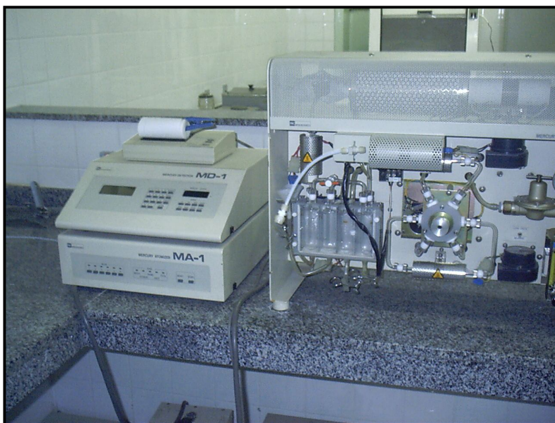
Figura 5 - Aparelhagem utilizada nas avaliações da dosagem do mercúrio (Mercury Analyser SP3D/NIC).
