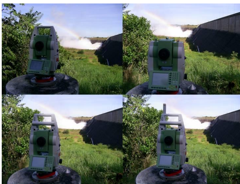
FIGURA 4.24 – Instalação da antena de rádio na TCRA1205 FONTE: O autor (2007)
