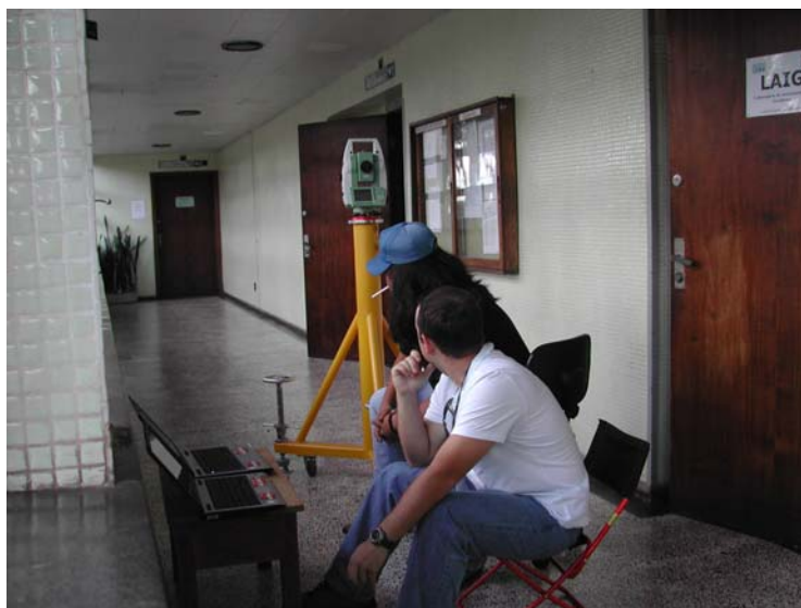
FIGURA 4.22 – Experimento de recepção de dados via Bluetooth ® usando o HyperTerminal . FONTE: O autor (2007)
