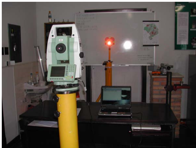
FIGURA 4.14 – Experimento de Recepção de dados via cabo usando o HyperTerminal FONTE: O autor (2007)
