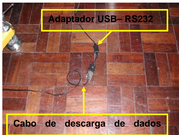
FIGURA 4.8 – Ligação do cabo da estação com o adaptador USB-Serial FONTE: O AUTOR
