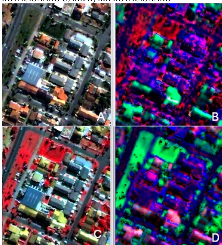
FIGURA 13 – EXEMPLO DA ROTAÇÃO DO ESPAÇO DE CORES. A) RGB B) RGB ROTACIONADO C) IRB D) IRB ROTACIONADO
