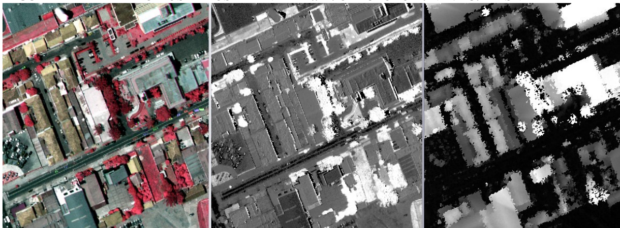
FIGURA 12 – EXEMPLO DOS DADOS DE ENTRADA: A. ORTOFOTO B. NDVI C. MDSN
