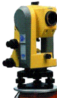
FIGURA 3.4: ESTAÇÃO TOTAL ELETRÔNICA TRIMBLE - 3305 DR
