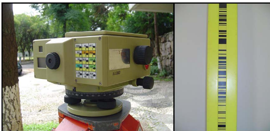
FIGURA 5.5 – NÍVEL NA 3003, MIRA DE CÓDIGO DE BARRAS (DETALHE)
