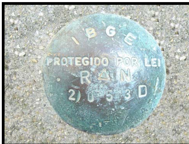
FIGURA 2.11 – CHAPA METÁLICA - REFERÊNCIA DE NÍVEL – RN 2053-D
