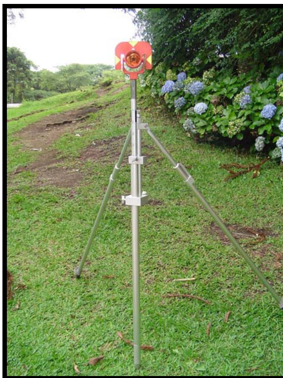
FIGURA 4.1 – CONJUNTO BASTÃO-PRISMA APOIADO POR BIPÉ
