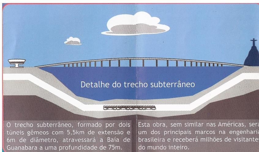
O trecho subterrâneo, formado por dois túneis gêmeos com 5,5km de extensão e 6m de diâmetro, atravessará a Baía de Guanabara a uma profundidade de 75m.
