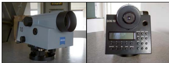
FIGURA 42–NÍVEL ZEISS DINI 10
