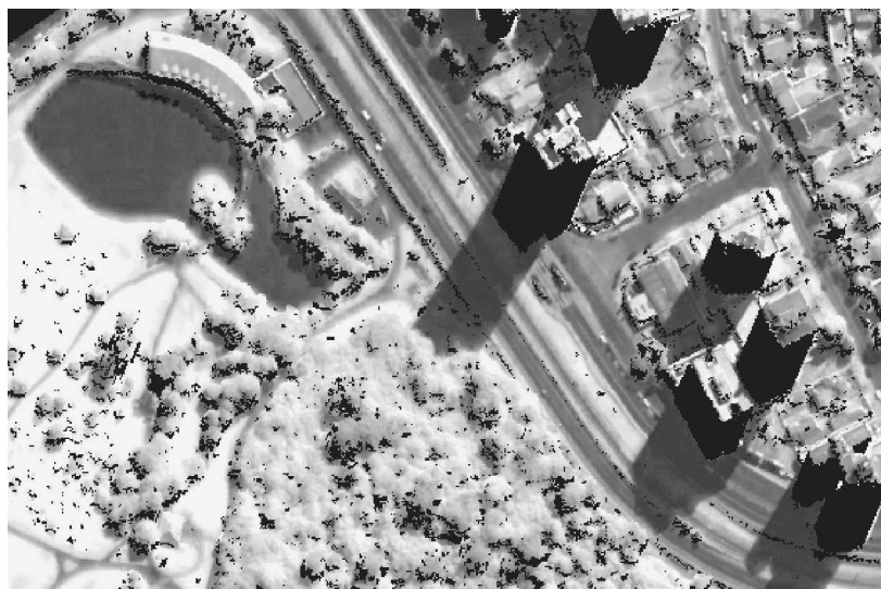
FIGURA 5.11 - APLICAÇÃO DA MÁSCARA COM AS ÁREAS DE OCLUSÃO PARA A REGIÃO DE EDIFICAÇÕES MAIS ALTAS.
