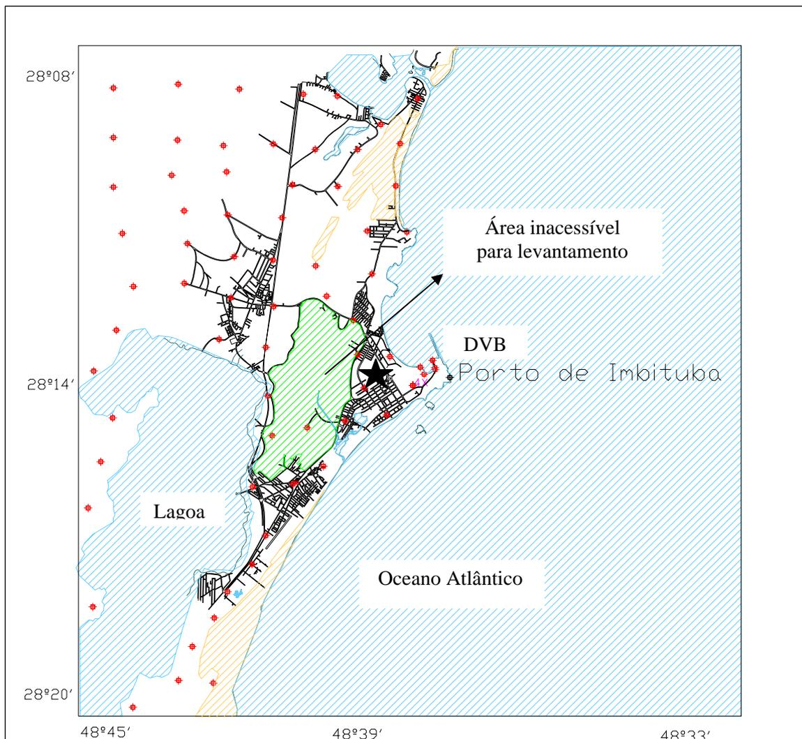
O tempo de ocupação dos pontos foi definido em função da distância da linha de base (10 km), buscando agilidade no levantamento e garantindo dessa forma a resolução das ambigüidades do sistema GPS.
