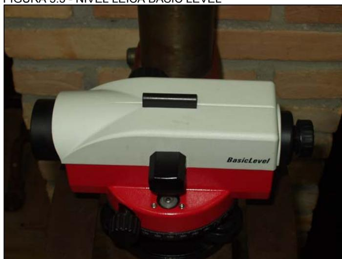
Após a conclusão dos testes simplificados, foi realizado o teste completo com apenas um nível, o Leica. Com este mesmo instrumento, após a conclusão dos trabalhos com a ISO, foram realizados os testes referentes à norma DIN.
