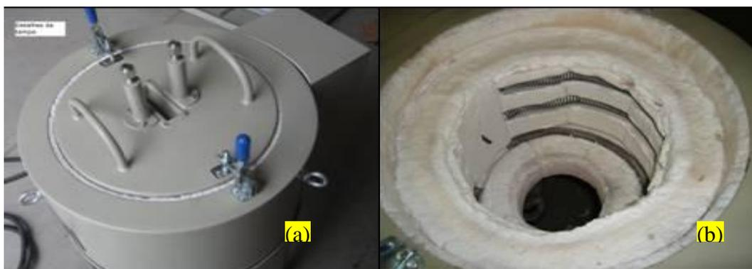
Figura 4.7: Foto do forno utilizado na fusão do magnésio
