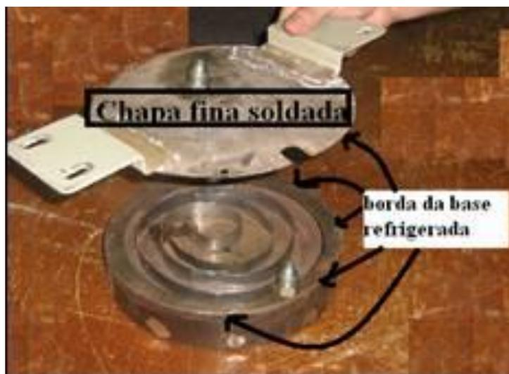
Figura 4.11: Sistema de resfriamento alternativo após danificação do sistema por serpentina.
