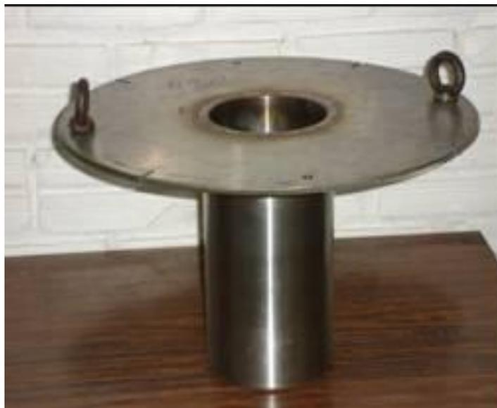
Figura 4.9: Cadinho alternativo construído em aço 420.
