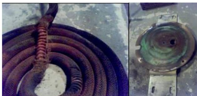
Figura 4.10: Sistema de resfriamento danificado devido à intensa oxidação durante realização do experimento.
