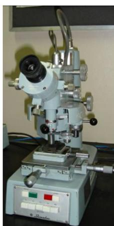
Figura 4.27: Aparelho para medir microdureza.
