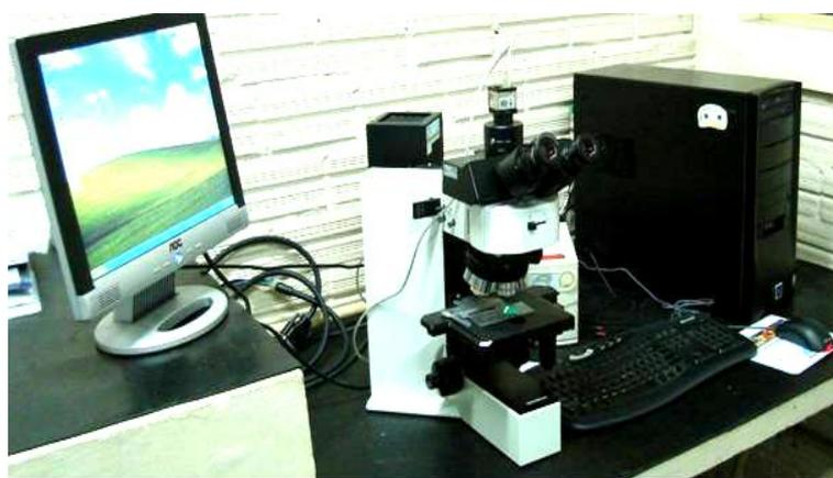
Figura 4.18: Microscópio Óptico com sistema de aquisição de imagens
