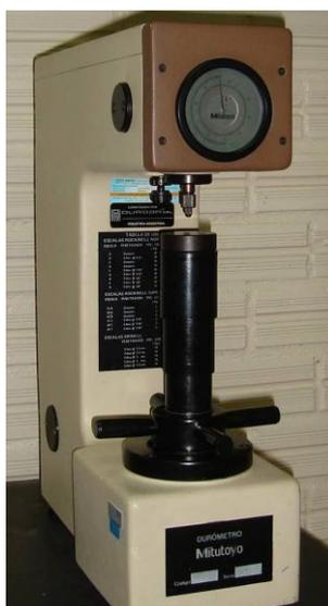
Figura 4.26: Durômetro Mitutoyo
