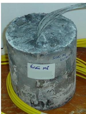
Figura 5.4: Lingote de magnésio solidificado no aparato experimental de solidificação unidirecional.
