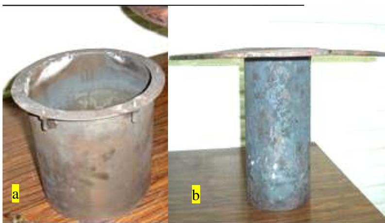
Figura 4.8: Cadinho de aço(SAE 1020), utilizado no forno de solidificação unidirecional.
