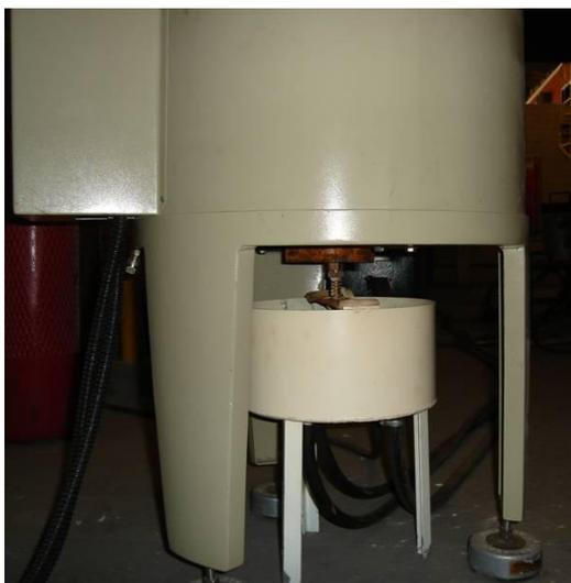
Figura 4.13: Sistema de captura da água de refrigeração
