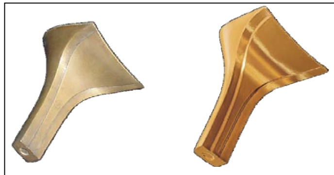
Figura 48 - Salto de sapato feminino, (a) modelo físico em latão e (b) modelo virtual. Fonte: digitalização 3D e imagem realizadas pelo autor.
