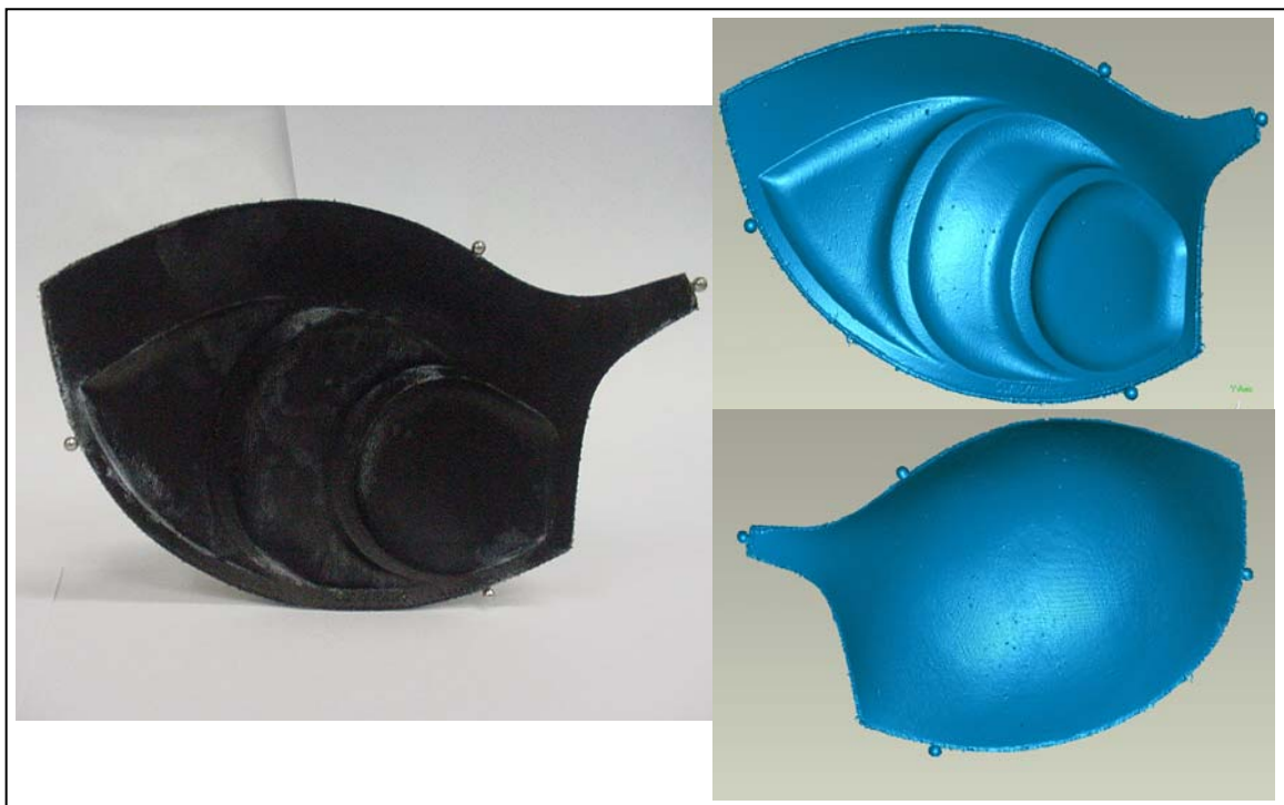
Figura 46 - Registro de nuvens de pontos através de esferas de referência. Fonte: digitalização 3D e imagem realizadas pelo autor.
