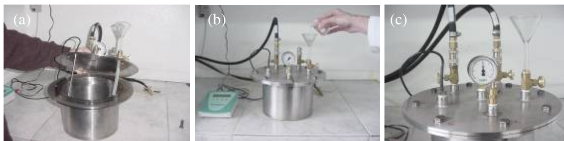
Figura 11: (a) Câmara aberta com o funil de dosagem (b) Dosagem do monômero sob vácuo (c) Câmara pressurizada a 2 bar.
