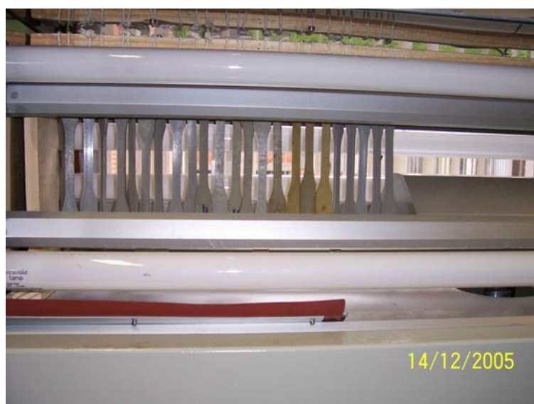
Figura 19 – Corpos-de-prova para ensaio de fotodegradação por radiação UV.
