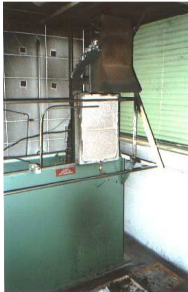
Figura 2 – Aparelho que determina o índice de propagação superficial de chama ( I_p ) – FONTE: IPT.
