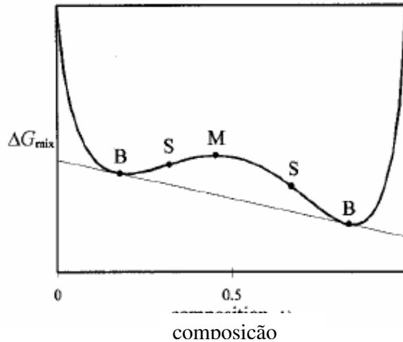
Figura 4 – Variação da energia livre de Gibbs de mistura ( $\Delta G_M$ ) em função da composição para uma mistura polimérica parcialmente miscível. Os pontos B são os pontos binodais, os pontos S são os pontos espinodais, onde a curva apresenta um ponto de inflexão. O ponto M representa o valor máximo de  $\Delta G_M$  entre os pontos espinodais [50].
