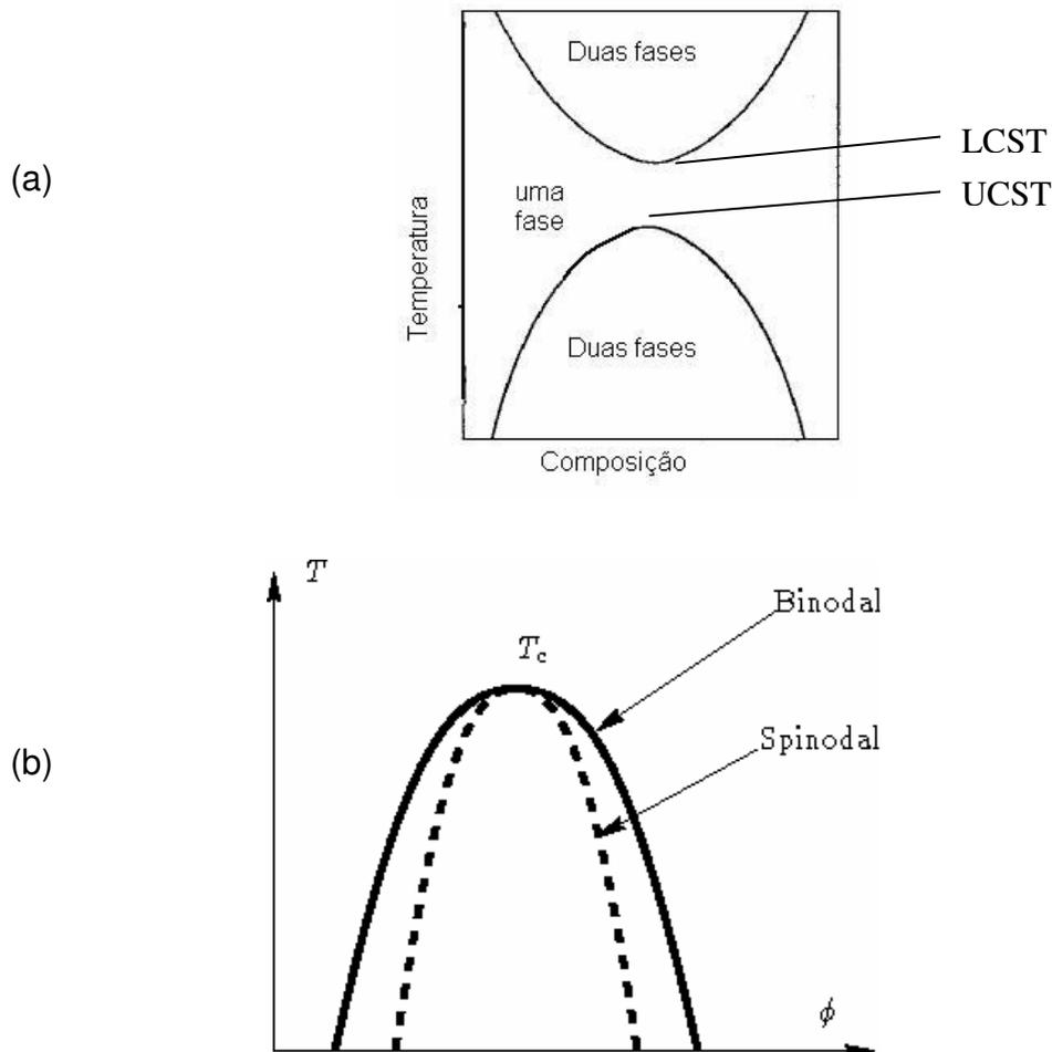
Figura 3– Diagrama de fase temperatura *versus* composição; (a) curvas binodais correspondentes às temperaturas consolutas de solução superior (UCST) e inferior (LCST); (b) linhas binodal e spinodal para uma mistura polimérica que exibe UCST (adaptado de [49]).
