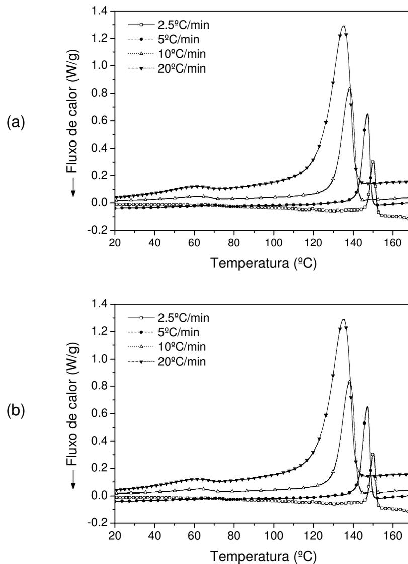
Figura A1 -Curvas de cristalização não isotérmica a várias taxas de resfriamento do PVDF puro processadas em misturador (a) LSM e (b) HSM.
