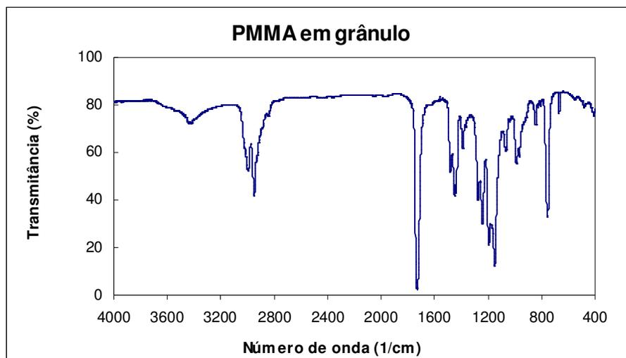
Figura 36 - Espectro FTIR de PMMA em grânulo.
