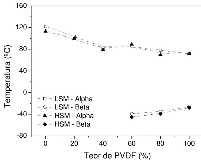
Figura 33 – Temperaturas de transição alfa e beta, obtidas por DMA, em função do teor de PVDF.
