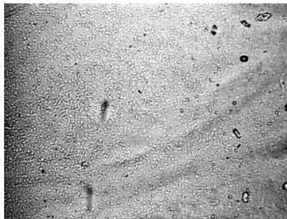
Figura 54 – Micrografia de MO de PVDF puro processado em misturador HSM a 160°C em (a) 2 min; (b) 3 min e (c) 4 min (aumento 200x).
