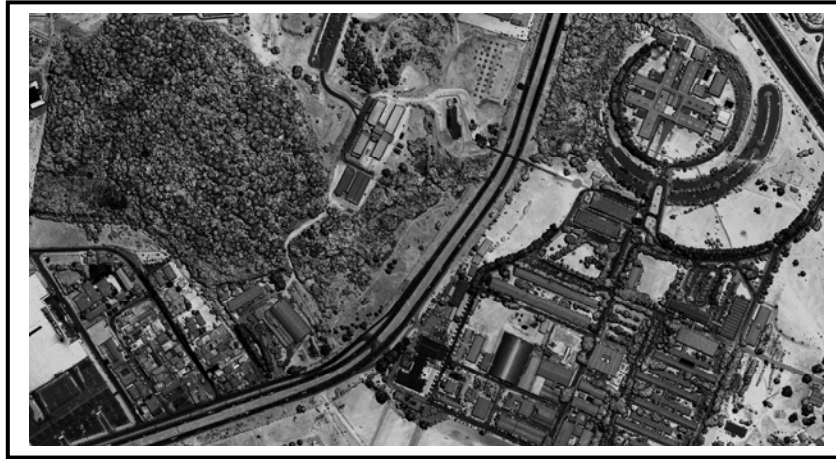
FIGURA 11 – IMAGEM GERADA A PARTIR DA INTENSIDADE DE RETORNO DO PULSO LASER
