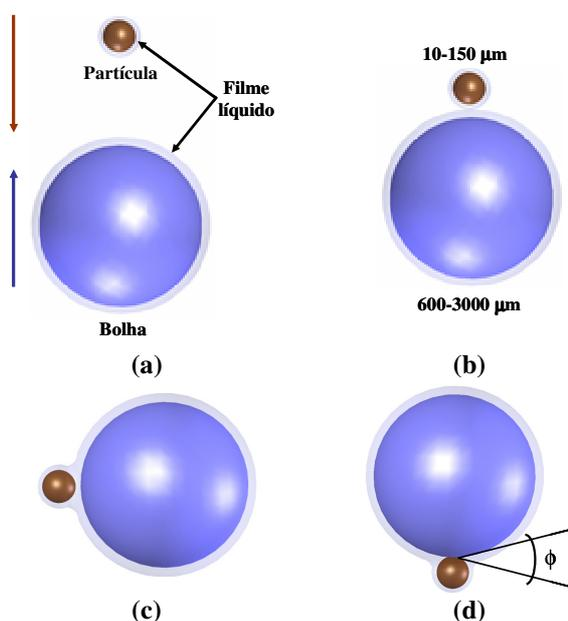
**Figura 8.** Fenômeno de captura bolha-partícula. (a) aproximação bolha-partícula; (b) colisão bolha-partícula; (c) indução – tempo de adelgaçamento do filme líquido; (d) ruptura do filme líquido e formação de um ângulo de contato.
