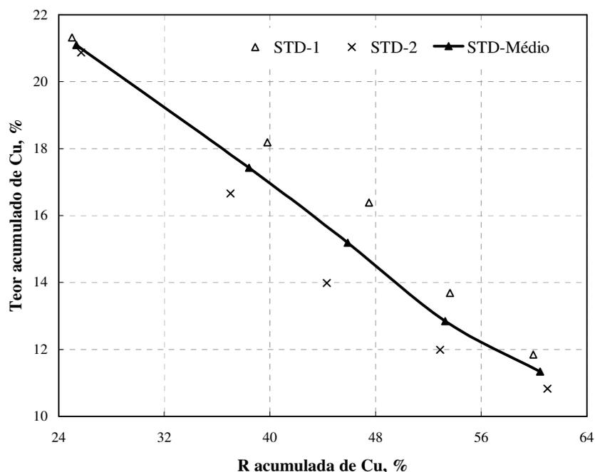
**Figura 40.** Estudos de flotação STD de sulfetos de cobre: Curva teor/recuperação de cobre. Condições dos ensaios: reagentes: [SF-113] = 30 g·t<sup>-1</sup>; [SF-506] = 8 g·t<sup>-1</sup>; [DF250] = 25 g·t<sup>-1</sup>; pH = 10,5; 38 % sólidos p/p; agitador 1000 rpm.
