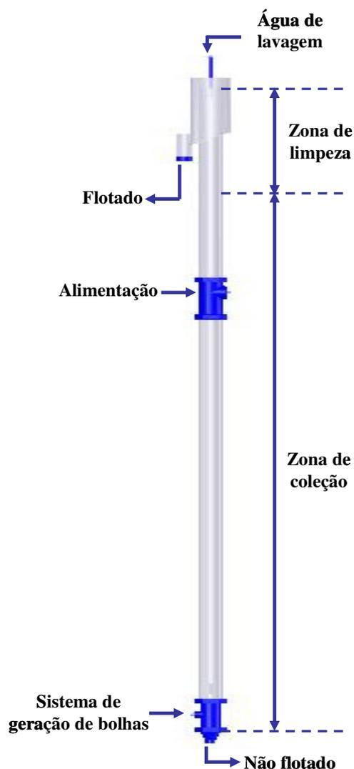
**Figura 3.** Esquema básico de uma coluna de flotação.
