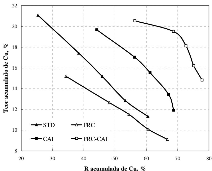
**Figura 46.** Estudos de flotação STD, com condicionamento em alta intensidade e reciclo de concentrado (FRC-CAI), CAI e FRC de sulfeto de cobre: Curvas comparativas de teor/recuperação de cobre. Condições dos ensaios: reagentes: [SF-113] =  $30 \text{ g}\cdot\text{t}^{-1}$ ; [SF-506] =  $8 \text{ g}\cdot\text{t}^{-1}$ ; [DF250] =  $25 \text{ g}\cdot\text{t}^{-1}$ ; pH = 10,5; 38 % sólidos p/p; agitador 1000 rpm (CAI e FRC-CAI: 1400 rpm por 3 minutos).
