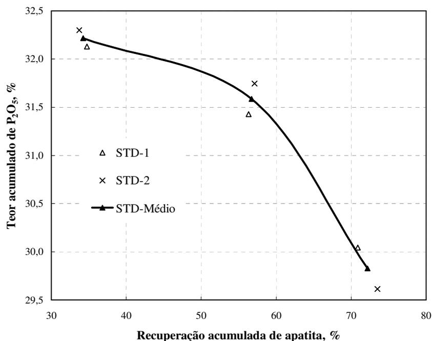
**Figura 54.** Estudos de flotação STD de minério de fosfato: Curva teor de P<sub>2</sub>O<sub>5</sub>/recuperação de apatita. Condições dos ensaios: reagentes: [fubá de milho] = 1400 g·t<sup>-1</sup>; [óleo de soja] = 80 g·t<sup>-1</sup>; pH = 12; 12 % sólidos p/p; agitador 300 rpm.
