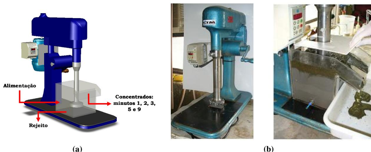
**Figura 29.** (a) Desenho esquemático do sistema utilizado; e (b) fotos da célula de flotação e detalhe da formação da camada de espuma nos estudos de com minério sulfetado de cobre.
