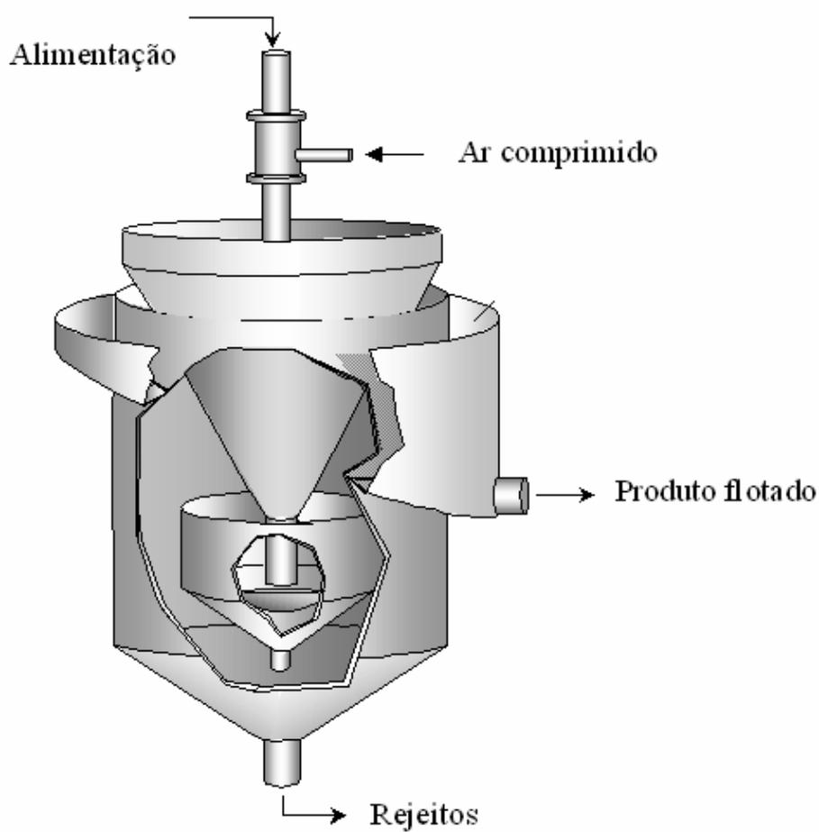
**Figura 24.** Célula de Flotação Pneumática.
