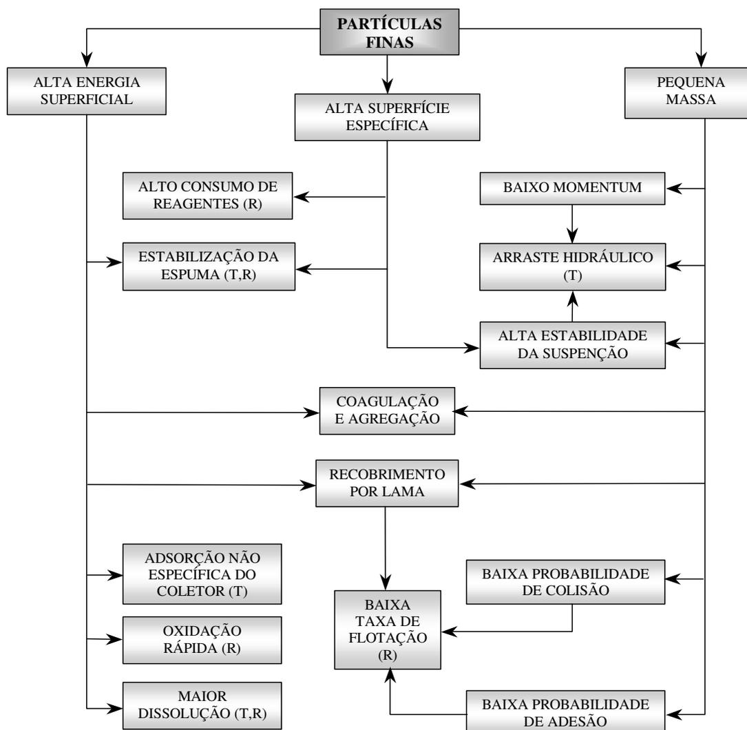
**Figura 11.** Relação entre as propriedades físicas e químicas das partículas finas e seu comportamento na flotação. T e R indica se o fenômeno afeta o teor e/ou a recuperação, respectivamente. As flechas indicam os vários fatores que contribuem para um particular fenômeno observado na flotação de partículas finas (adaptada de Subrahmanyam e Forssberg, 1990).
