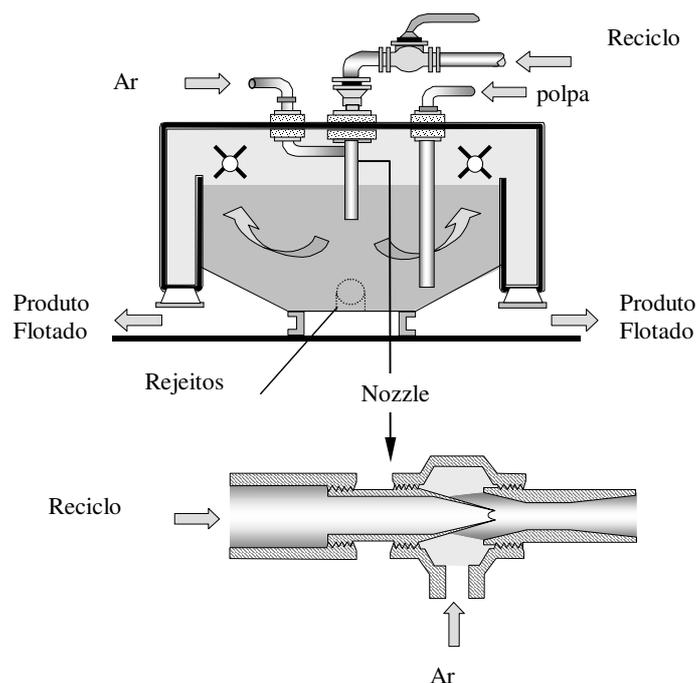
**Figura 4.** Unidade de flotação *Nozzle*.
