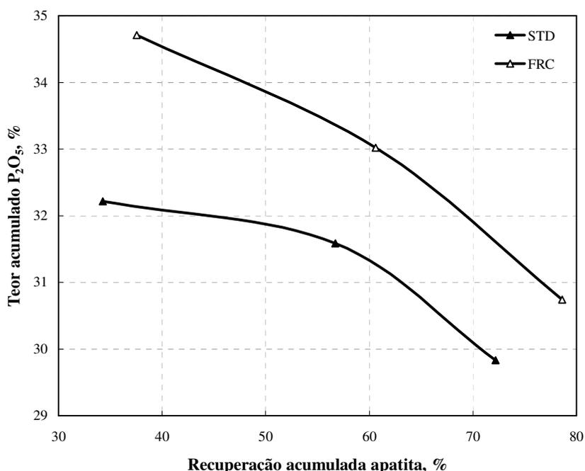
**Figura 56.** Estudos de flotação com reciclo de concentrado (FRC) de minério de fosfato. Curvas comparativas de teor de P<sub>2</sub>O<sub>5</sub>/recuperação de apatita. Condições dos ensaios: reagentes: [fubá de milho] = 1400 g·t<sup>-1</sup>; [óleo de soja] = 80 g·t<sup>-1</sup>; pH = 12; 12 % sólidos p/p; agitador 300 rpm.
