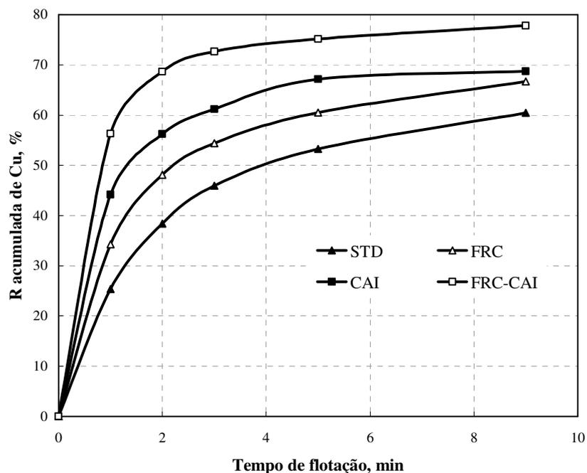
**Figura 45.** Estudos comparativos de flotação STD, com condicionamento em alta intensidade e reciclo de concentrado (FRC-CAI), CAI e FRC de sulfeto de cobre: Resultados de recuperação metalúrgica de cobre em função do tempo de flotação. Condições dos ensaios: reagentes: [SF-113] = 30 g·t<sup>-1</sup>; [SF-506] = 8 g·t<sup>-1</sup>; [DF250] = 25 g·t<sup>-1</sup>; pH = 10,5; 38 % sólidos p/p; agitador 1000 rpm (CAI e FRC-CAI: 1400 rpm por 3 minutos).
