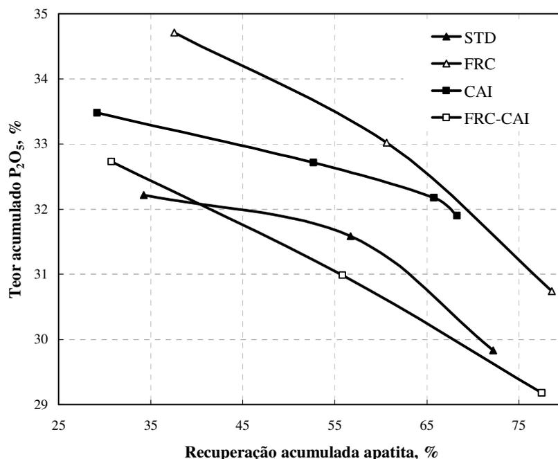
**Figura 60.** Estudos de flotação STD, com condicionamento em alta intensidade e reciclo de concentrado (FRC-CAI), CAI e FRC de minério de fosfato: Curva comparativas de teor de  $P_2O_5$ /recuperação de apatita. Condições dos ensaios: reagentes: [fubá de milho] =  $1400 \text{ g}\cdot\text{t}^{-1}$ ; [óleo de soja] =  $80 \text{ g}\cdot\text{t}^{-1}$ ; pH = 12; 12 % sólidos p/p; agitador 300 rpm (CAI e FRC-CAI: 750 rpm por 3 minutos).
