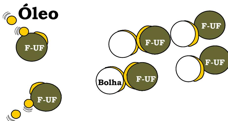
**Figura 15.** Fenômenos envolvidos no processo de flotação extensora ("extender flotation"): formação de bolhas oleosas e interação com partículas cobertas com óleo.
