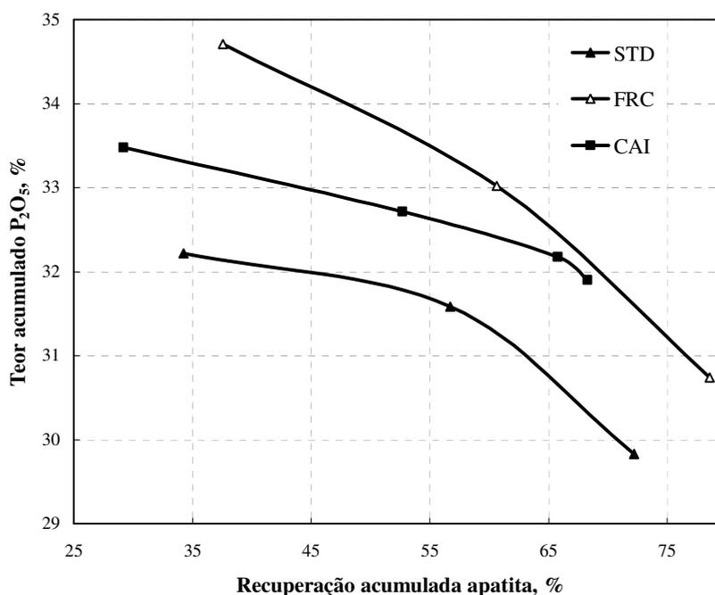
**Figura 58.** Estudos de flotação STD, com condicionamento em alta intensidade (CAI) e FRC de minério de fosfato: Curvas comparativas de teor de P<sub>2</sub>O<sub>5</sub>/recuperação de apatita. Condições dos ensaios: reagentes: [fubá de milho] = 1400 g·t<sup>-1</sup>; [óleo de soja] = 80 g·t<sup>-1</sup>; pH = 12; 12 % sólidos p/p; agitador 300 rpm (CAI: 750 rpm por 3 minutos).
