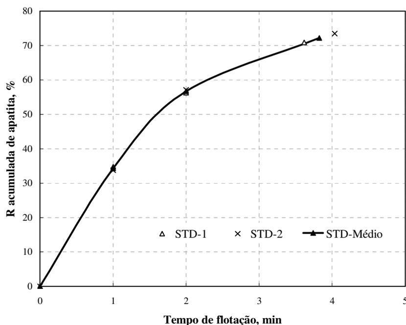
**Figura 53.** Estudos de flotação STD de minério de fosfato: Resultados de recuperação de apatita em função do tempo de flotação. Condições dos ensaios: reagentes: [fubá de milho] = 1400 g-t-1; [óleo de soja] = 80 g-t-1; pH = 12; 12 % sólidos p/p; agitador 300 rpm.
