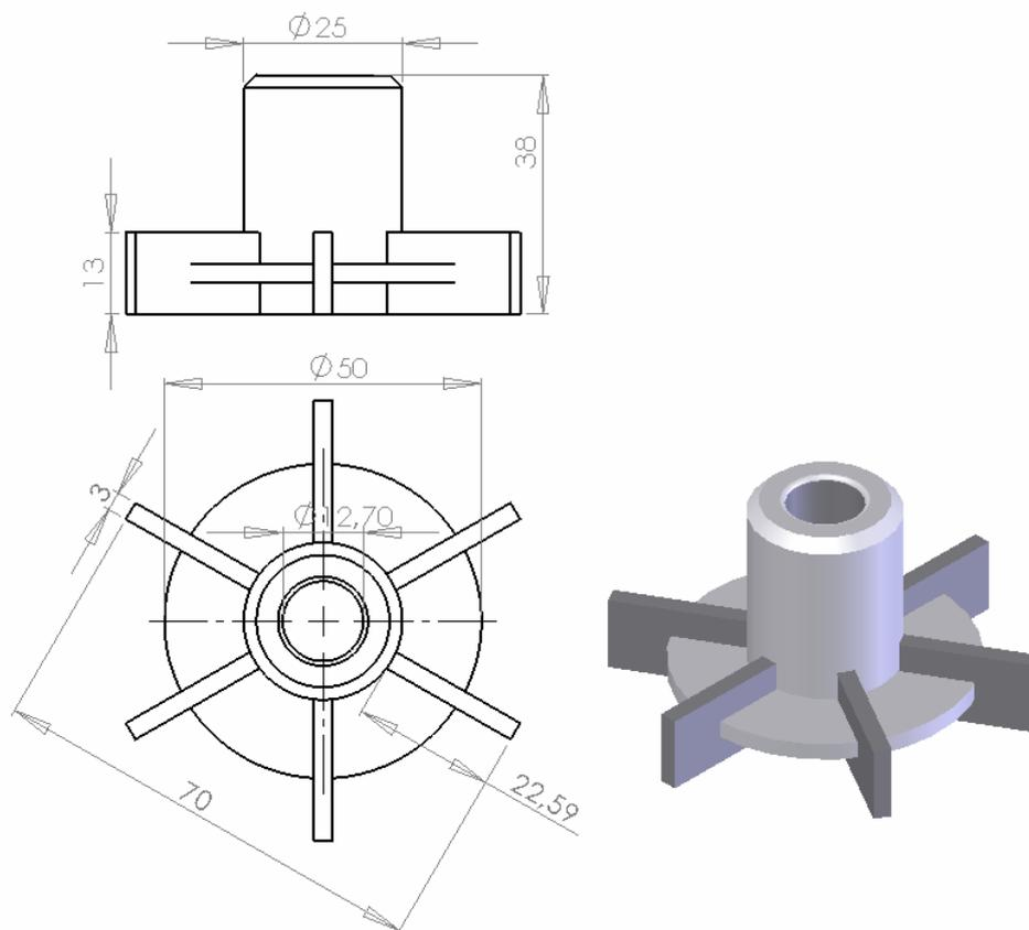
**Figura 35.** Impelidor tipo “Turbina Rushton” de 6 aletas.
