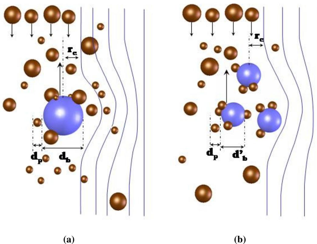
**Figura 7.** Fenômeno de “captura” (colisão + adesão) de partículas de diâmetro  $d_p$  por bolhas de diâmetro  $d_b$  dentro de um raio crítico  $r_c$ . Comparação entre bolhas (a) grandes e (b) pequenas.
