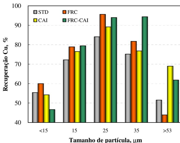
**Figura 52.** Recuperação de cobre por faixa granulométrica, nas frações >53, 35, 25, 15 e <15 µm, dos produtos concentrados dos estudos de flotação STD, FRC, CAI e FRC-CAI com minério sulfetado de cobre. Condições dos ensaios: reagentes: [SF-113] = 30 g·t<sup>-1</sup>; [SF-506] = 8 g·t<sup>-1</sup>; [DF250] = 25 g·t<sup>-1</sup>; pH = 10,5; 38 % sólidos p/p; agitador 1000 rpm (CAI e FRC-CAI: 1400 rpm por 3 minutos).
