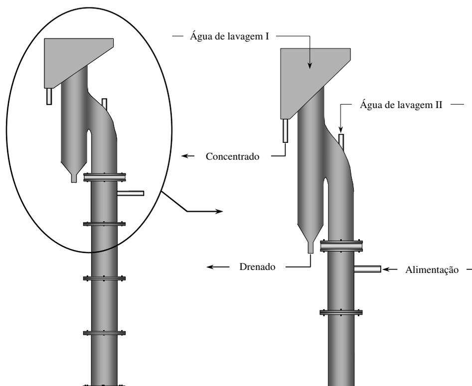
**Figura 19.** Célula tipo coluna de três produtos - C3P.
