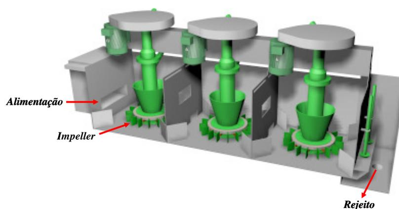
**Figura 2.** Células de flotação por ar induzido - FAI.
