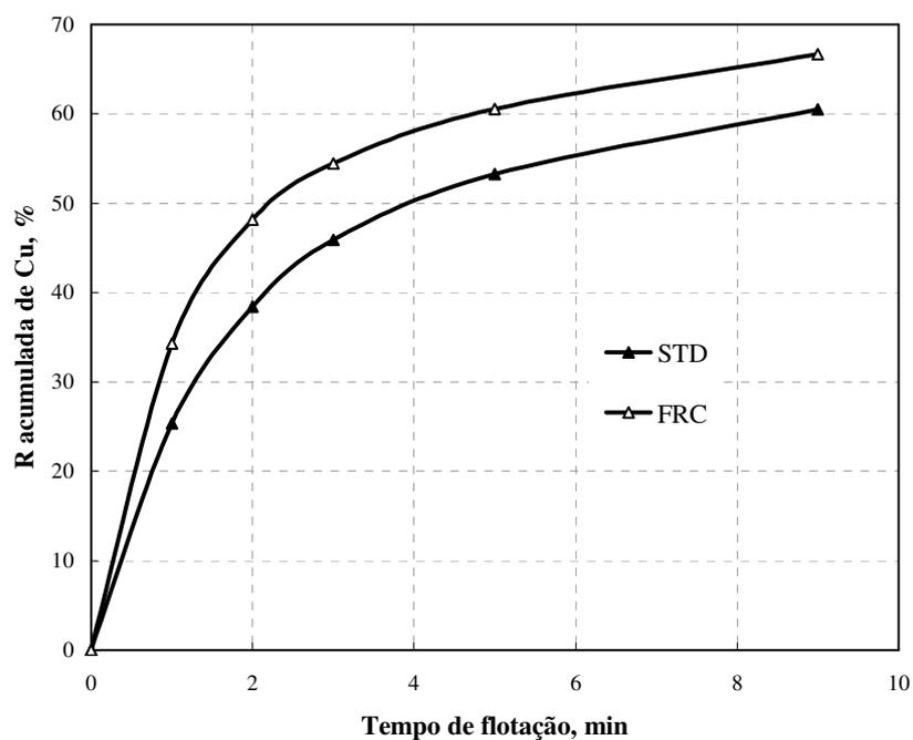
**Figura 41.** Estudos comparativos de flotação STD e com reciclo de concentrado (FRC) de sulfeto de cobre: Resultados de recuperação metalúrgica de cobre em função do tempo de flotação. Condições dos ensaios: reagentes: [SF-113] = 30 g·t<sup>-1</sup>; [SF -506] = 8 g·t<sup>-1</sup>; [DF250] = 25 g·t<sup>-1</sup>; pH = 10,5; 38 % sólidos p/p; agitador 1000 rpm.
