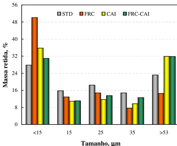
**Figura 51.** Distribuição granulométrica, nas frações >53, 35, 25, 15 e <15  $\mu\text{m}$ , dos produtos concentrados dos estudos de flotação STD, FRC, CAI e FRC-CAI com minério sulfetado de cobre. Condições dos ensaios: reagentes: [SF-113] = 30  $\text{g}\cdot\text{t}^{-1}$ ; [SF-506] = 8  $\text{g}\cdot\text{t}^{-1}$ ; [DF250] = 25  $\text{g}\cdot\text{t}^{-1}$ ; pH = 10,5; 38 % sólidos p/p; agitador 1000 rpm (CAI e FRC-CAI: 1400 rpm por 3 minutos).
