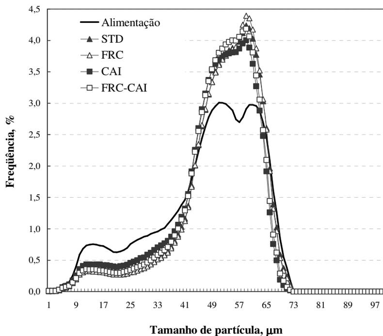
**Figura 62.** Estudos de flotação de minério de fosfato. Distribuição granulométrica média de partículas no produto concentrado dos estudos de flotação STD, FRC, CAI e FRC-CAI em comparação com a alimentação.
