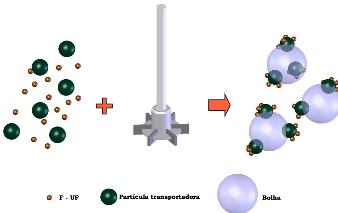
**Figura 17.** Adesão por heteroagregação e flotação transportadora.
