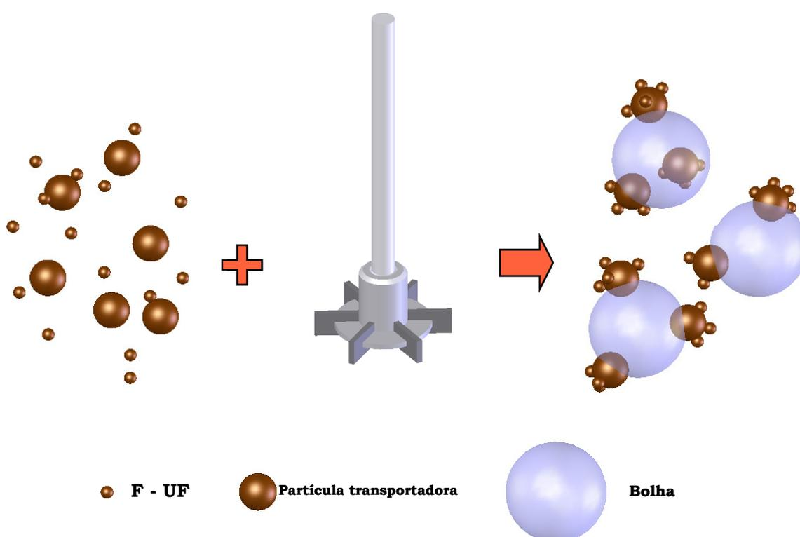
**Figura 16.** Adesão por homoagregação e flotação autotransportadora.
