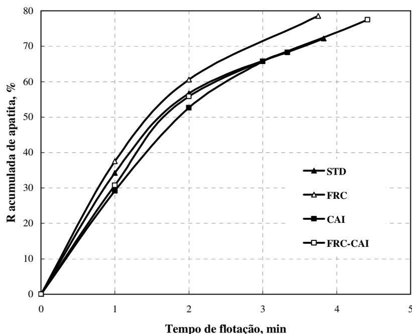
**Figura 59.** Estudos comparativos de flotação STD, com condicionamento em alta intensidade e reciclo de concentrado (FRC-CAI), CAI e FRC de minério de fosfato: Resultados de recuperação acumulada de apatita em função do tempo de flotação. Condições dos ensaios: reagentes: [fubá de milho] = 1400 g·t<sup>-1</sup>; [óleo de soja] = 80 g·t<sup>-1</sup>; pH = 12; 12 % sólidos p/p; agitador 300 rpm (CAI e FRC-CAI: 750 rpm por 3 minutos).
