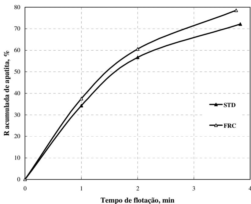
**Figura 55.** Estudos comparativos de flotação STD e com reciclo de concentrado (FRC) de minério de fosfato: Resultados de recuperação acumulada de apatita em função do tempo de flotação. Condições dos ensaios: reagentes: [fubá de milho] = 1400 g·t<sup>-1</sup>; [óleo de soja] = 80 g·t<sup>-1</sup>; pH = 12; 12 % sólidos p/p; agitador 300 rpm.
