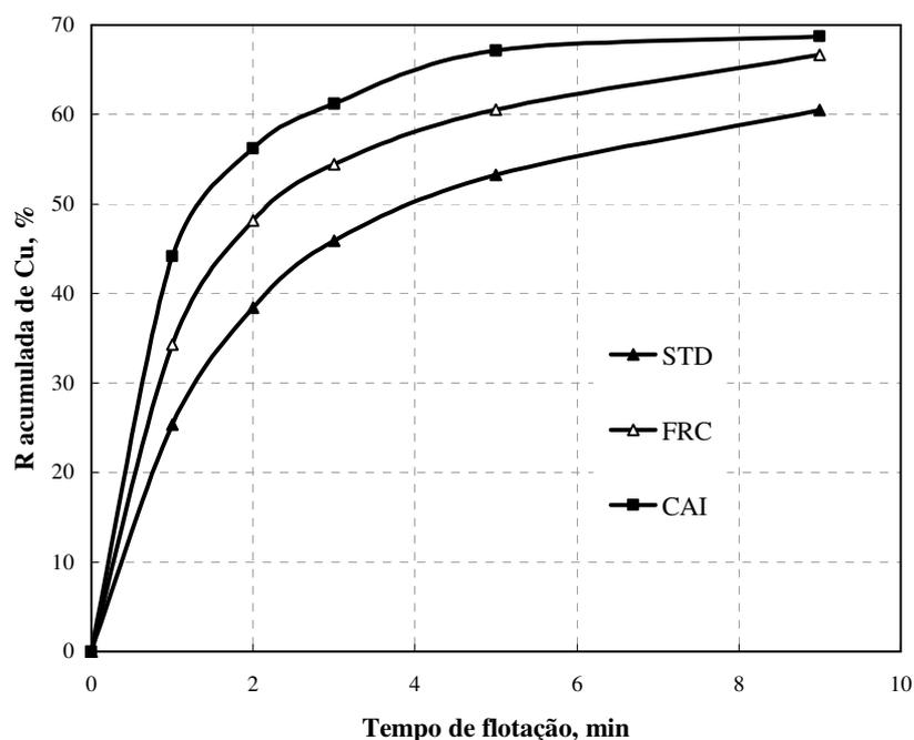
**Figura 43.** Estudos comparativos de flotação STD, com condicionamento em alta intensidade (CAI) e FRC de sulfeto de cobre: Resultados de recuperação metalúrgica de cobre em função do tempo de flotação. Condições dos ensaios: reagentes: [SF-113] = 30  $\text{g}\cdot\text{t}^{-1}$ ; [SF-506] = 8  $\text{g}\cdot\text{t}^{-1}$ ; [DF250] = 25  $\text{g}\cdot\text{t}^{-1}$ ; pH = 10,5; 38 % sólidos p/p; agitador 1000 rpm (CAI: 1400 rpm por 3 minutos).
