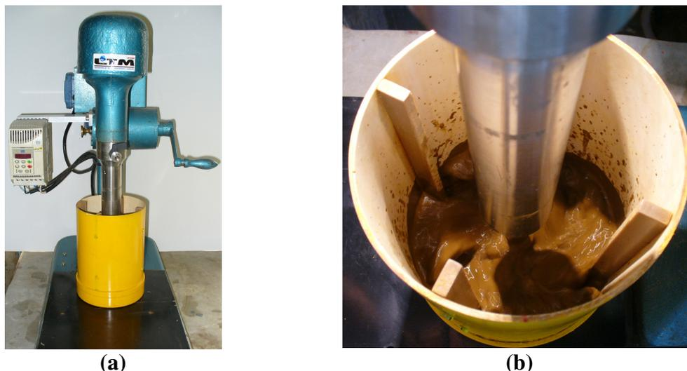
**Figura 38.** Fotos dos estudos de flotação com condicionamento em alta intensidade (CAI) com minério de fosfato: (a) Detalhe do tanque de condicionamento acoplado à máquina de flotação DENVER D-12; e (b) detalhe do condicionamento com defletores (baffles).
