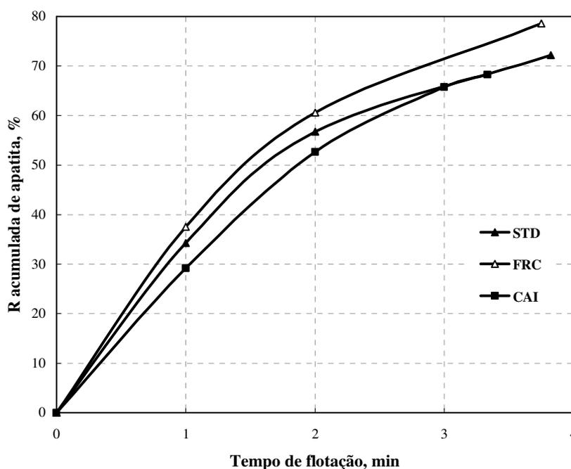
**Figura 57.** Estudos comparativos de flotação STD, com condicionamento em alta intensidade (CAI) e FRC de minério de fosfato: Resultados de recuperação acumulada de apatita em função do tempo de flotação. Condições dos ensaios: reagentes: [fubá de milho] = 1400 g·t<sup>-1</sup>; [óleo de soja] = 80 g·t<sup>-1</sup>; pH = 12; 12 % sólidos p/p; agitador 300 rpm (CAI: 750 rpm por 3 minutos).
