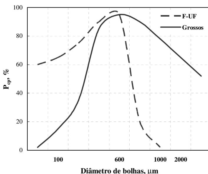
**Figura 9.** Influência do diâmetro de bolhas na probabilidade de captura de partículas ( $P_{cp}$ ) finas e ultrafinas (F-UF) e grossas.
