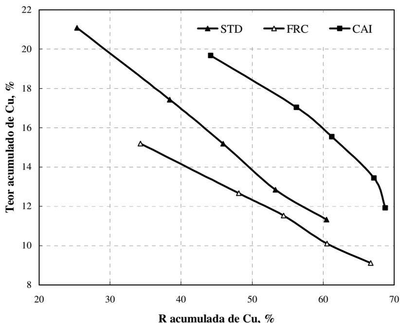
**Figura 44.** Estudos de flotação STD, com condicionamento em alta intensidade (CAI) e FRC de sulfetos de cobre. Curvas comparativas teor/recuperação de cobre. Condições dos ensaios: reagentes: [SF-113] =  $30 \text{ g}\cdot\text{t}^{-1}$ ; [SF-506] =  $8 \text{ g}\cdot\text{t}^{-1}$ ; [DF250] =  $25 \text{ g}\cdot\text{t}^{-1}$ ; pH = 10,5; 38 % sólidos p/p; agitador 1000 rpm (CAI: 1400 rpm por 3 minutos).
