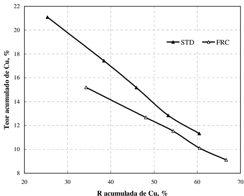
**Figura 42.** Estudos de flotação STD e com reciclo de concentrado (FRC) de sulfeto de cobre: Curva comparativas teor/recuperação de cobre. Condições dos ensaios: reagentes: [SF-113] = 30 g·t<sup>-1</sup>; [SF-506] = 8 g·t<sup>-1</sup>; [DF250] = 25 g·t<sup>-1</sup>; pH = 10,5; 38 % sólidos p/p; agitador 1000 rpm.
