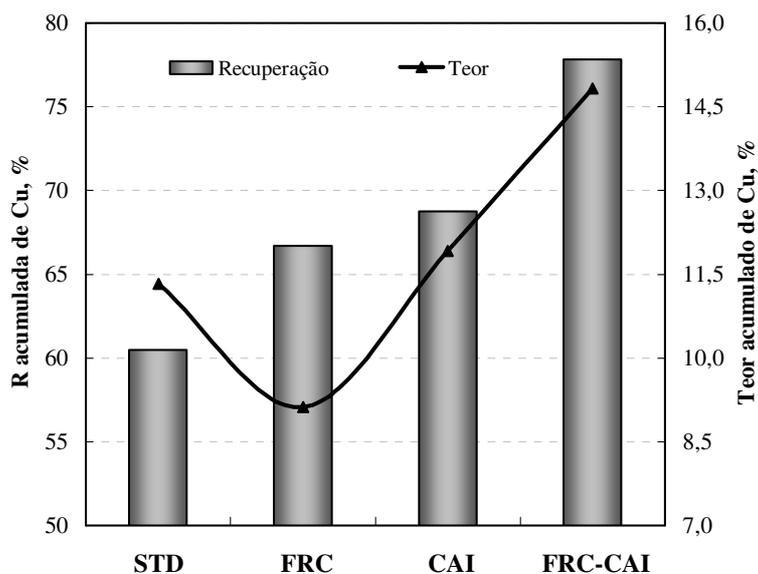
**Figura 47.** Estudos de flotação STD, FRC, CAI e FRC-CAI de sulfetos de cobre. Comparativo dos valores de recuperação e teores acumulados de cobre.
