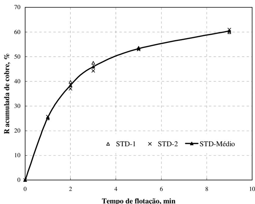
**Figura 39.** Estudos de flotação STD de sulfetos de cobre: Recuperação metalúrgica de cobre em função do tempo de flotação. Condições dos ensaios: reagentes: [SF-113] = 30 g·t<sup>-1</sup>; [SF-506] = 8 g·t<sup>-1</sup>; [DF250] = 25 g·t<sup>-1</sup>; pH = 10,5; 38 % sólidos p/p; agitador 1000 rpm.
