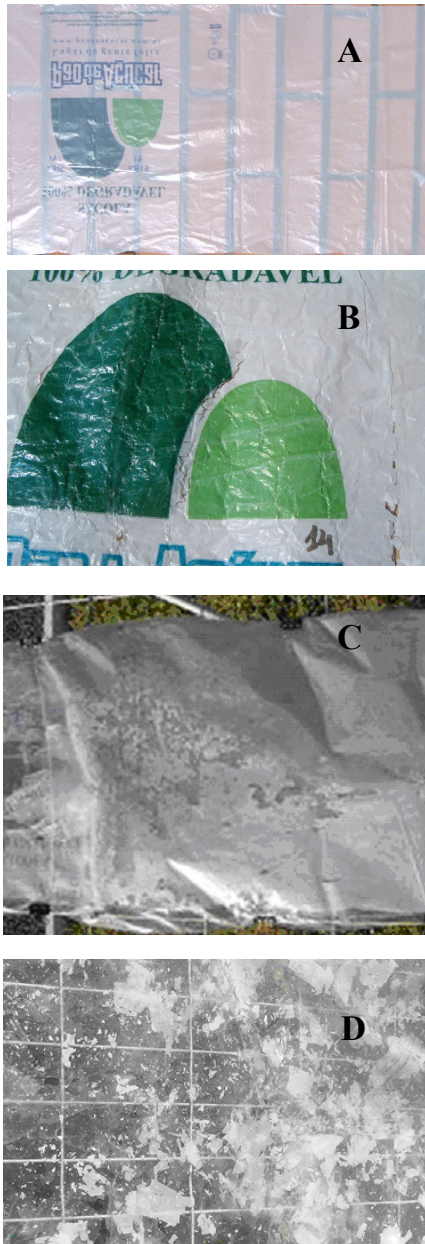
Figura 17 – Fotografias de sacola de PE na plataforma, inicial (A) e após 80 (B) , 136 (C) e 365 (D) dias de exposição ao intemperismo natural.
