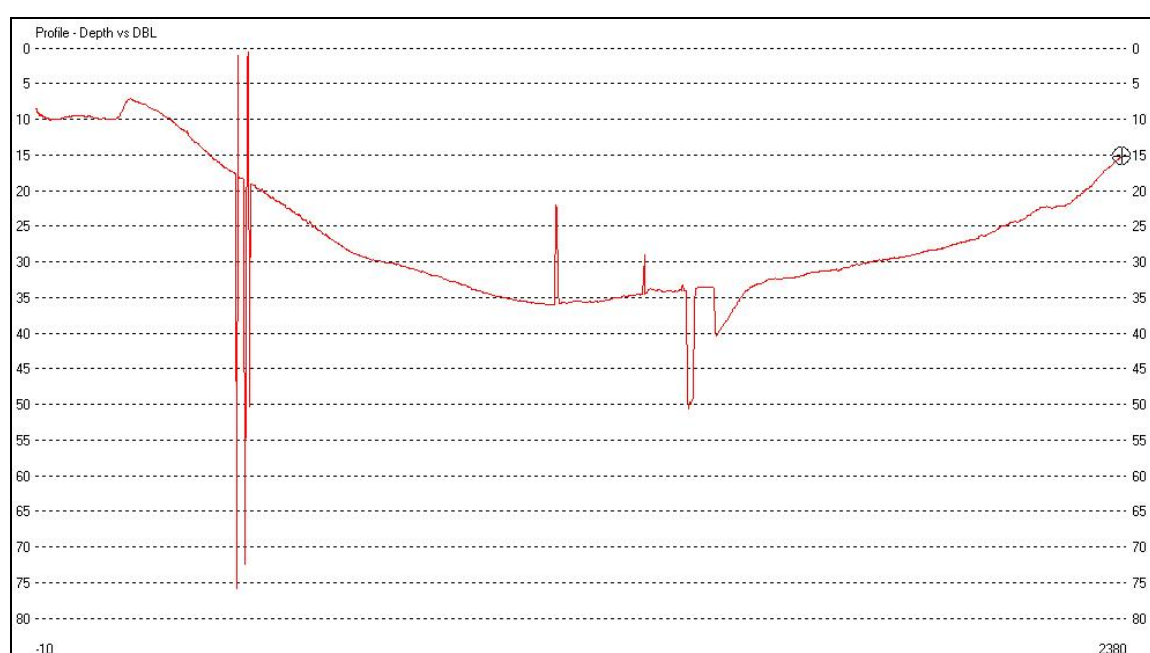
FIGURA 72 - SPIKES DE SONDAGEM DA LINHA EW6 (ARQUIVO 2006SO2091219_6.RAW) ASSOCIADAS AO RECEPTOR RTK TRIMBLE 7400 NO DIA 28 DE JULHO
