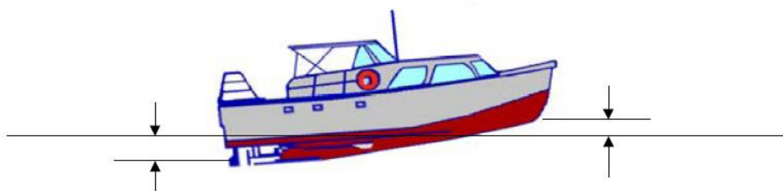
FIGURA 19 – VARIÇÃO DE CALADO ( SQUAT ) FONTE: USACE (2004)
