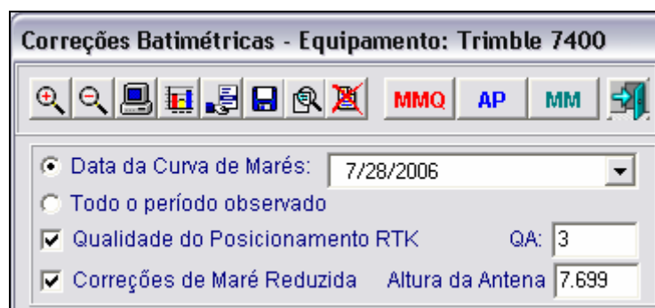
FIGURA 47 - FILTRAGEM DAS ALTITUDES ELIPSOIDAIIS E ALTURA DA ANTENA GPS RTK
