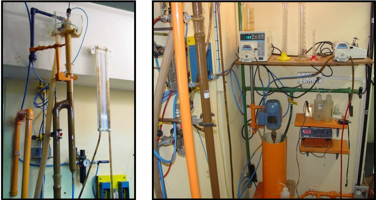
Figura 3.8. Coluna modificada de três produtos de laboratório (coluna de 1”). Detalhe da zona de inflexão e vista parcial do sistema utilizado para os estudos de flotação (Tanque pulmão de polpa; medidor de pH; bomba peristáltica para bombeamento da polpa).
