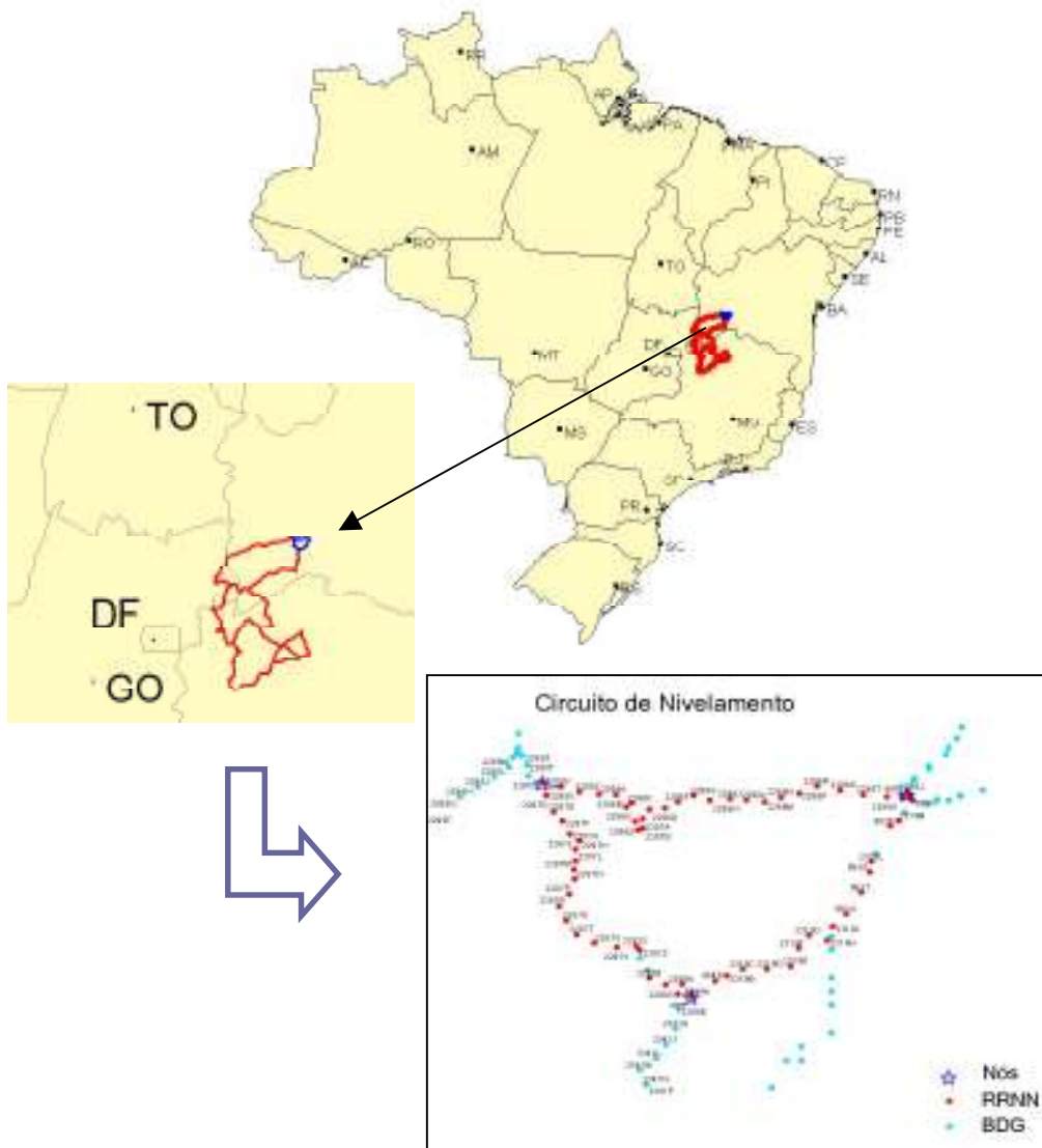
FIGURA 13 – EXEMPLO DE CIRCUITO DE NIVELAMENTO, COMPOSTO PELAS RRNN E NÓS
