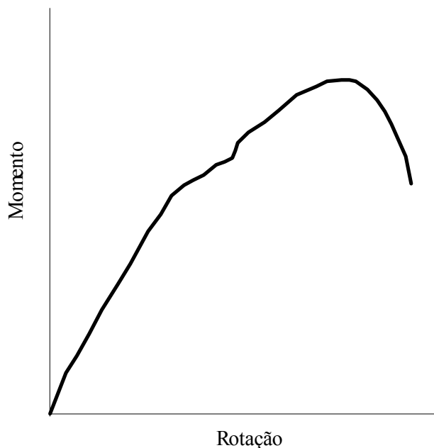
Figura 3.16 – Exemplo de curva momento-rotação obtida de ensaio experimental.
