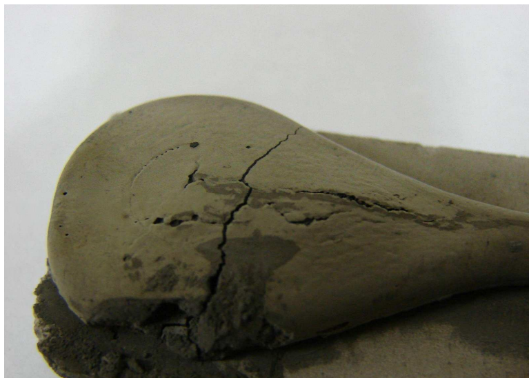
Figura 4.13: Amostra com defeito de inchamento na extração térmica.
