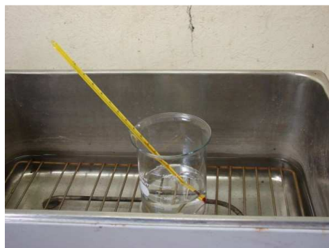
Figura 3.12: Cuba de banho termostático para extração por imersão.
